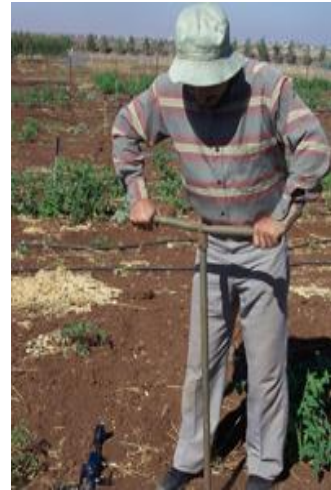
صورة (٨) أخذ عينات التربة لتقدير الأزوت صورة (٩) اسطوانة مسبار التربة المستخدم لأخذ عينات التربة
