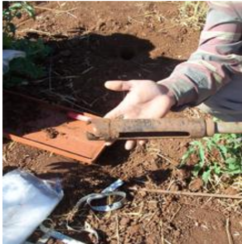
صورة (٨) أخذ عينات التربة لتقدير الأزوت صورة (٩) اسطوانة مسبار التربة المستخدم لأخذ عينات التربة
