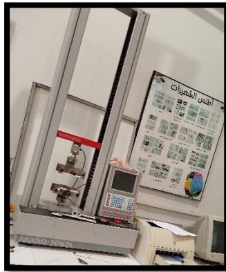
الشكل (6-10) جهاز اختبار الشد Testometric M350
