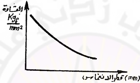
الشكل ( ٨ - ٣٥ ) : العلاقة بين قيم القساوة وقطر الانساس عند استخدام مطرقة غريفين
