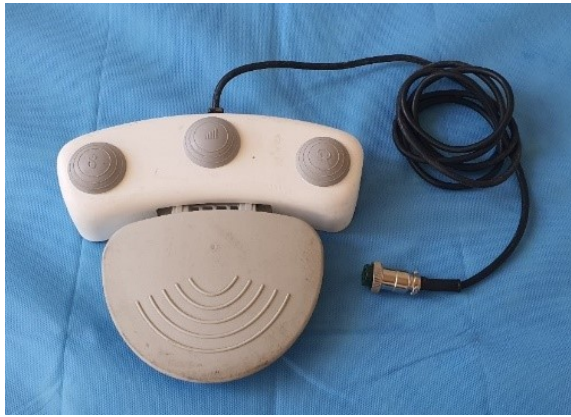
الشكل (4): لوحة التحكم الأرضية التابعة لجهاز الزرع
