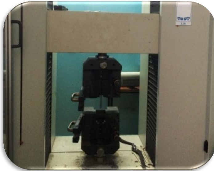
الشكل رقم (30) جهاز Universal testing machine
