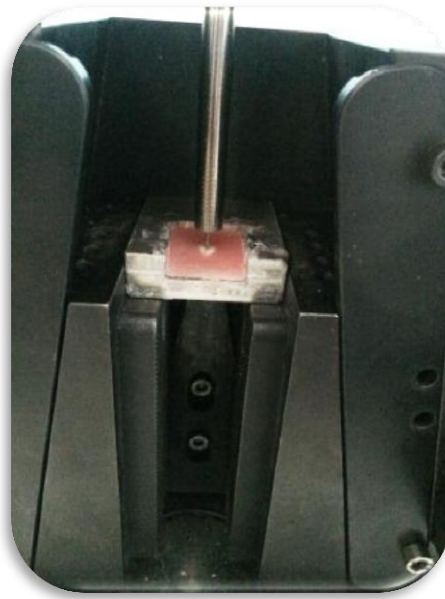
الشكل رقم (53) يوضح تعريض الحشوة الجذرية فقط في كل مقطع لحمل القوى المطبقة تم تسجيل الحمل الأعظمي قبل حدوث الفشل بالنيوتن.
