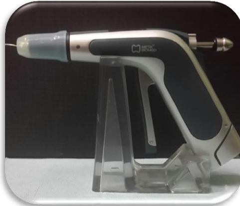
الشكل رقم (20) جهاز الحقن الحراري Obtura Gun
