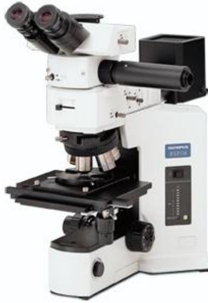
شكل (2-8) المجهر الرأسي ذو الضوء المنعكس Olympus Metallography BX41
