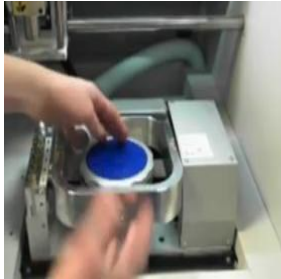
شكل (2-13) تثبيت القالب الشمعي في جهاز النحت
