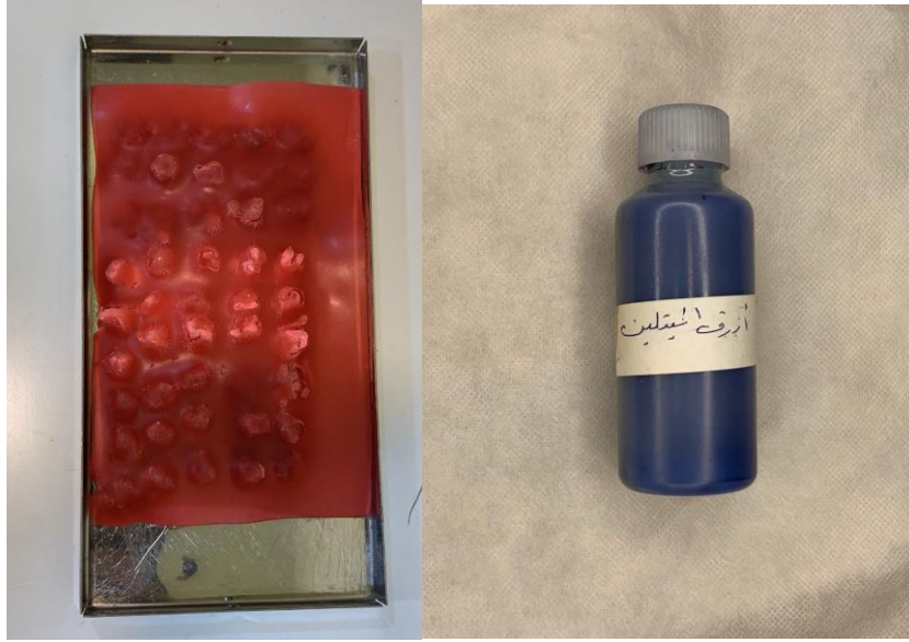
الشكل 32: صباغ أزرق الميتلين المستخدم في الدراسة وطريقة غمر تيجان العينات في الصباغ
