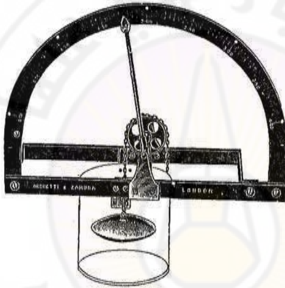
الشكل رقم (٢٢-ج) جهاز لياس التبخر ذو الكفة
