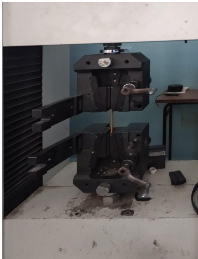
الشكل 4-3 جهاز اختبار الشد للمواد البلاستيكية.
