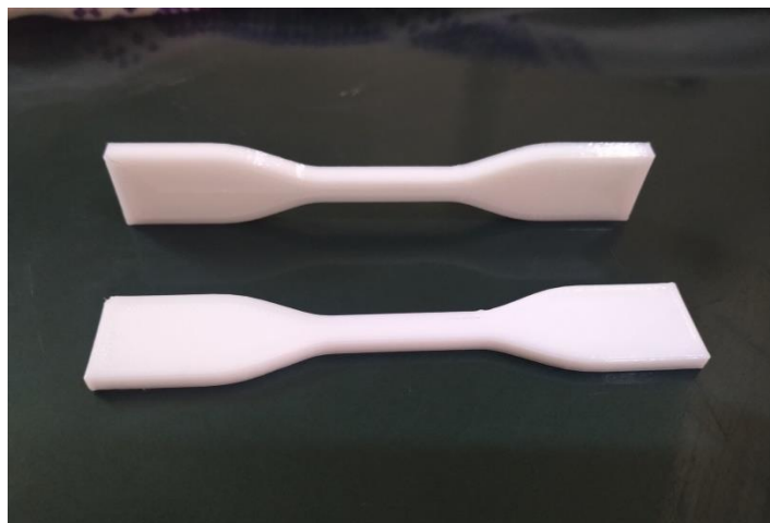
الشكل 4-5 العينة المعيارية ASTM D638 type 4
