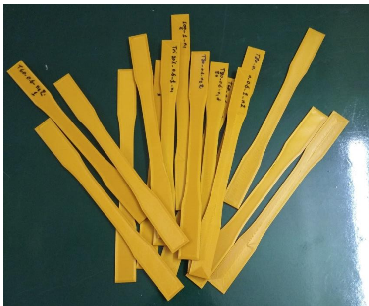
الشكل 4-11 بعض العينات المطبوعة قبل الاختبار.
