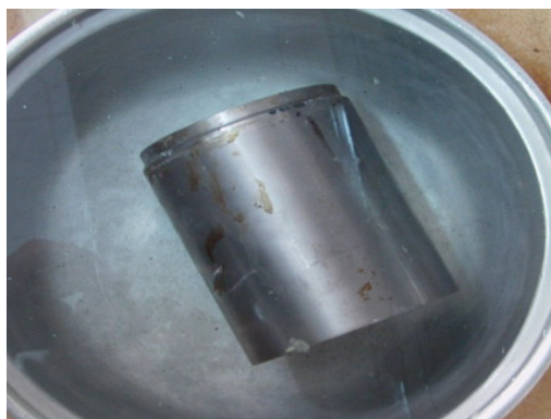
الشكل (14-2) : تطبيق الضغط الإصبعي الشكل (15-2) : غمر العينة في محم مائي
