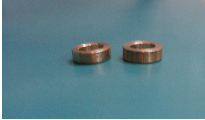
الشكل (2-9) القوالب الإسطوانية الخاصة بعينات اختبار مقاومة الانضغاط
