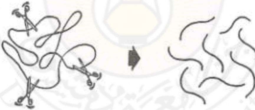
الشكل ( 4-57 ) : يتم إزالة جزيئات النشاء من خلال معالجة القماش بالأحماض acids أو الأنزيمات enzymes أو العوامل المؤكسدة oxidizing agents.
