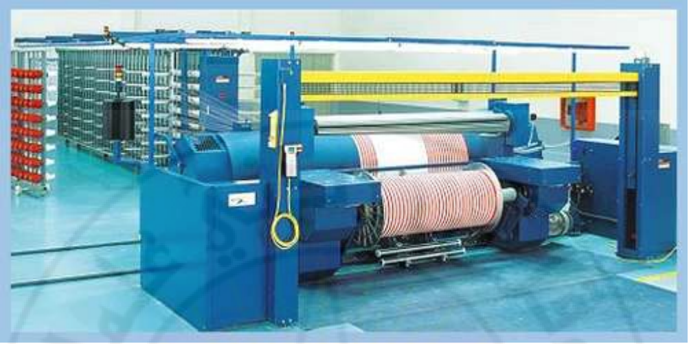
الشكل (3-4): التسدية غير المباشر (لتسدية الشقق) مع النصبية (الكريل) الموازية
