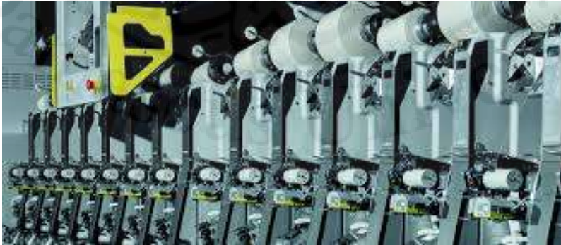
(الشكل 2-1): آلة تدوير سافيو Winding machines/ Savio
