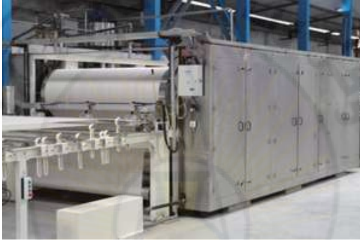
الشكل (4-49): أسطوانات التجفيف في آلة التنشئة
