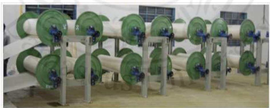
الشكل (4-13-أ): نسبة التغذية مع محركات مؤازرة servomotrs لقيادة مطاوي التغذية
