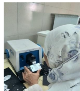
الشكل 12: تقطيع القوالب الشمعية بالميكروتوم
