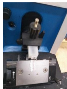
الشكل 12: تقطيع القوالب الشمعية بالميكروتوم
