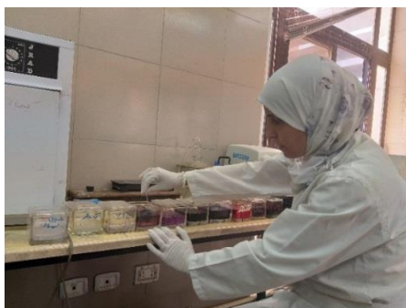
الشكل 14: وضع الشرائح في سلة التلوين وتمريها بالكحولات الشكل 15: تلوين المقاطع النباتية
