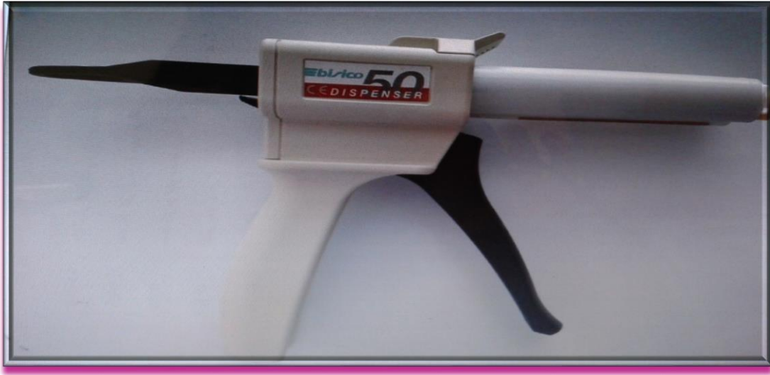
شكل (7,2) جهاز مزج مطاط بولي فينيل سيلوكسان
