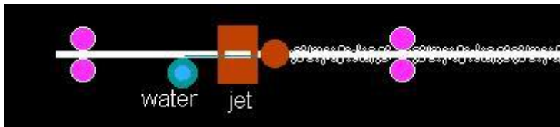
الشكل (24) مراحل التجعيد الهوائي للخيوط ذات التركيب السيللوزي
