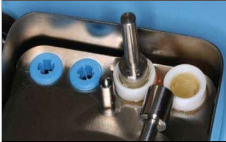
الشكل (7) استخدام المكبس لإجراء ضغط تدريجي لهلامة الـ PRF (Toffler et al., 2009)
