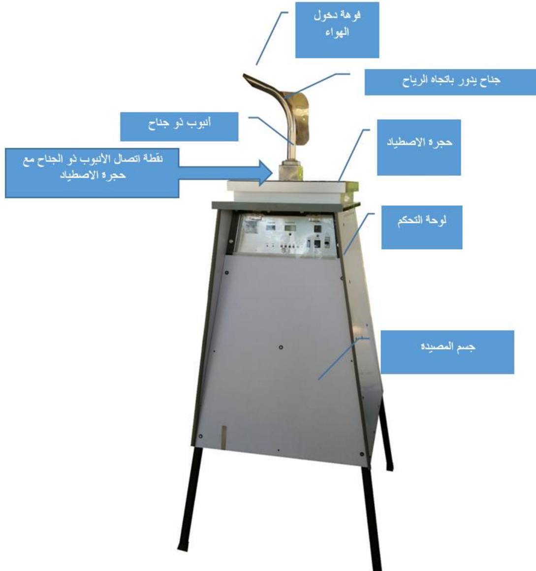
الشكل ( 8 ) : أجزاء المصيدة الحجمية الآلية
