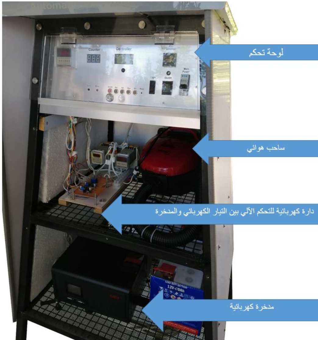
الشكل ( 9 ): الأجزاء الداخلية للمصيدة الحجمية الآلية الثابتة
