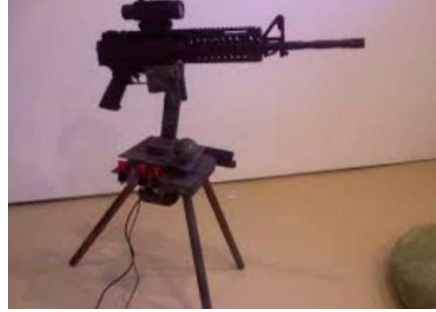
الشكل (1-1) روبوت الحراسة ذو البندقية الآلية
