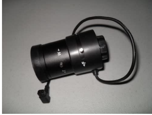
الشكل (3-4) مجموعة الجسميات التي تم تركيبها على الكاميرا المرئية
