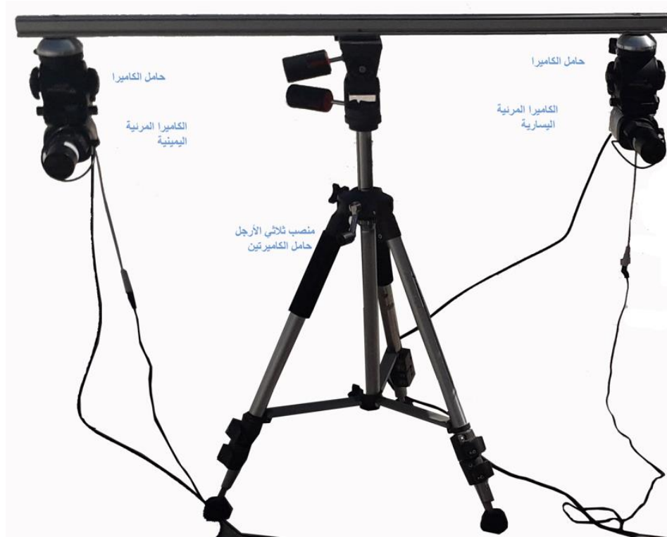
الشكل (4-17) المنصب الحامل للكاميرتين وآليات الضبط.
