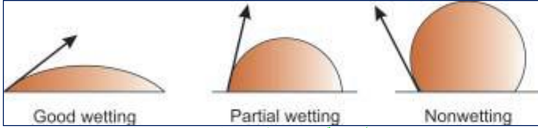
الشكل 2 : يبين تأثير زاوية التماس على قوة الارتباط (الالتصاق) بين السطحين.
