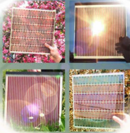
الشكل 9-4: خلية غريتل الصبغية Dye sensitized solar cells
