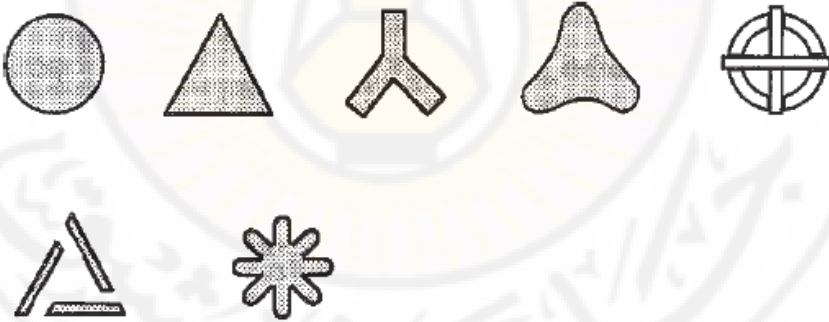
الشكل 2-2: أمثلة عن أشكال ثقب المغزل 2001 By Sulzer Textil Limited Switzerland
