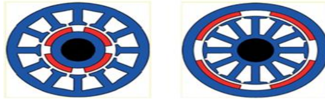
الشكل (2-22) الجزء الدوار الداخلي على اليسار، الجزء الدوار الخارجي على اليمين للمولد التزامني
