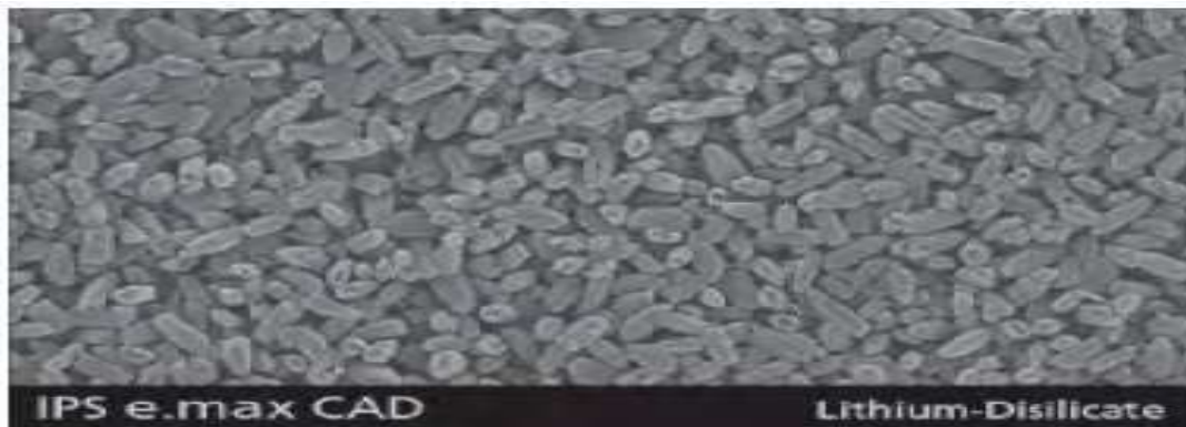
شكل (1-5) صورة بالمجهر الالكتروني ل IPS-E-max ( McLaren and Cao ) (2009)
