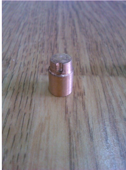
شكل (2-13) الدعامة المعدنية بعد إجراء الميزاب المانع للدوران
