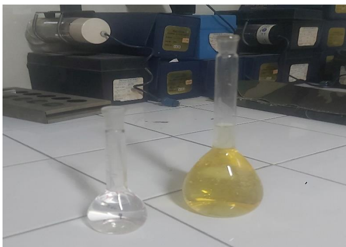
شكل (3-12): عينة الفضة النانوية الغروية بعد تخفيفها بمعدل 1000 مرة قبل القياس.
