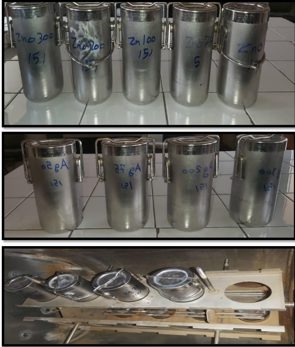
شكل (3-32): غسل العينات في غسالة مخبرية وفق المواصفة القياسية
