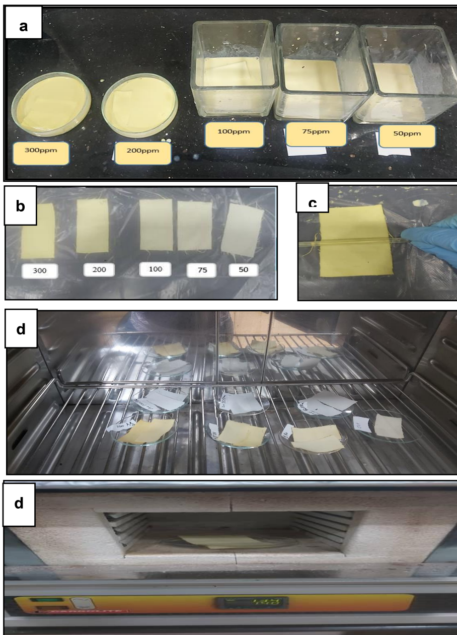
شكل (3-26): مراحل عملية الغمر-التجفيف-المعالجة الحرارية (pad-dry-cure) لمعالجة القماش القطني بتراكيز مختلفة من المركب النانوي Ag-C 6 F 6 (a) غمر العينات بمركب (b) عصر العينات (c) تجفيف العينات بدرجة حرارة 80°م (d) المعالجة الحرارية للعينات في الفرن
