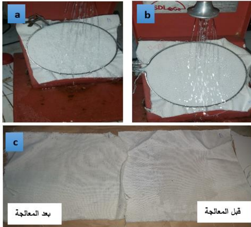
شكل (3-24): اختبار نفاذية الماء a: عينة قماش B قبل المعالجة على جهاز نفاذية الماء. b: العينة B بعد معالجتها بـ C_6F_6 c: مقارنة بين عينتين B قبل وبعد المعالجة.
