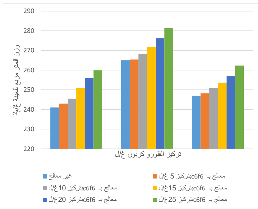
شكل (3-20): العلاقة بين تركيز مادة المعالجة C_6F_6 ووزن عينات القماش المعالجة
