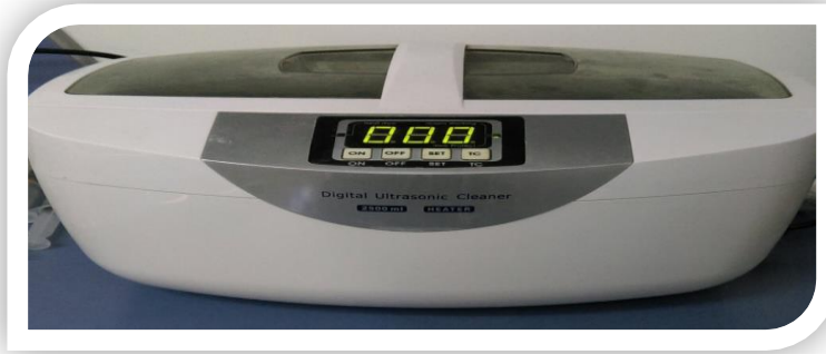
الشكل (7-3) جهاز تنظيف بالأمواج فوق الصوتية
