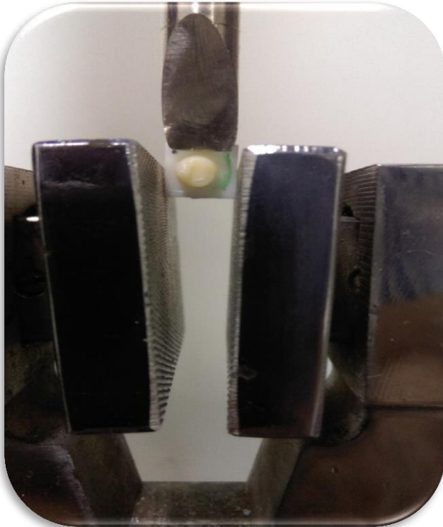
شكل (3-20) اختبار القص بمنظر أمامي
