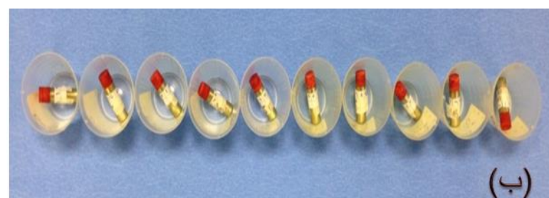
الشكل (44-2) 10 عينات من الراتنج كيميائي التماثر تم تخزينها في الهواء
