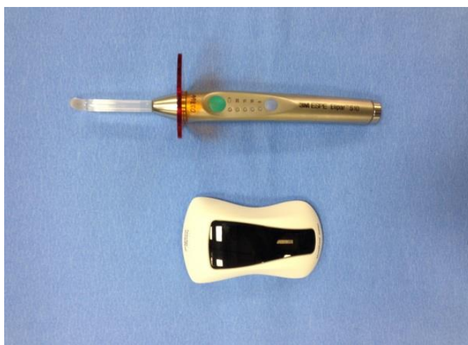
الشكل (2-11) جهاز التصليب الضوئي وجهاز قياس شدة الضوء
