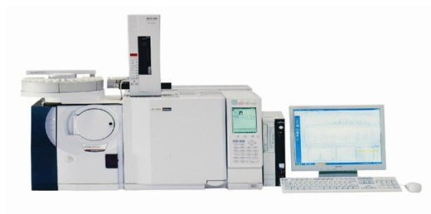
الشكل 13. جهاز الكروماتوغرافي الغازي الملحق بوحدة الكتلة GC- MS.
