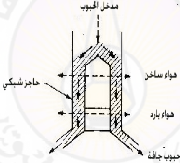
الشكل (4.3.6) المجفف ذو التدفق المستمر
