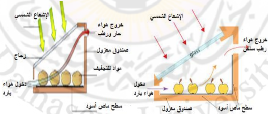
الشكل (4.4.3) المجفف الشمسي المباشر ذو الحمل الطبيعي
