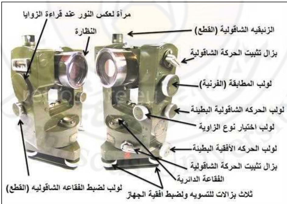
الشكل 6-11 بعض أجزاء جهاز الثيودوليت من نوع زايس
