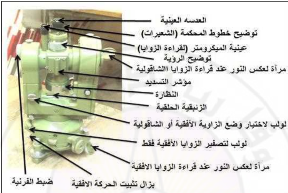
الشكل 6-10 بعض أجزاء جهاز الثيودوليت من نوع ويلد (Wild)
