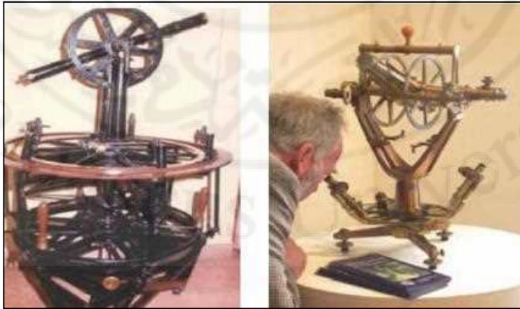
الشكل 1-3 نماذج لأجهزة ثيودوليت قديمة لقياس الزوايا
