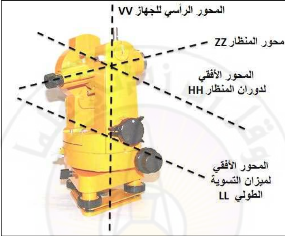
الشكل 6-4 محاور جهاز الثيودوليت
