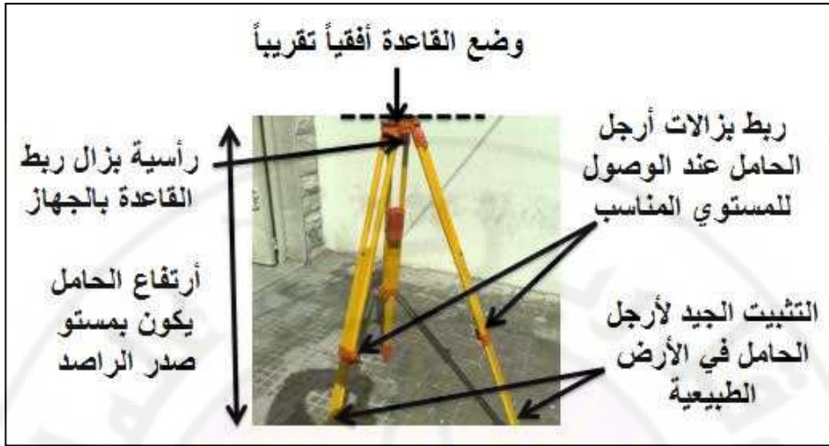
الشكل 6-16 معايير استعمال ركيزة الأرجل
