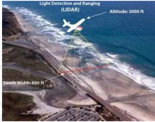
الشكل 10-13 المساح الليزري الجوي
