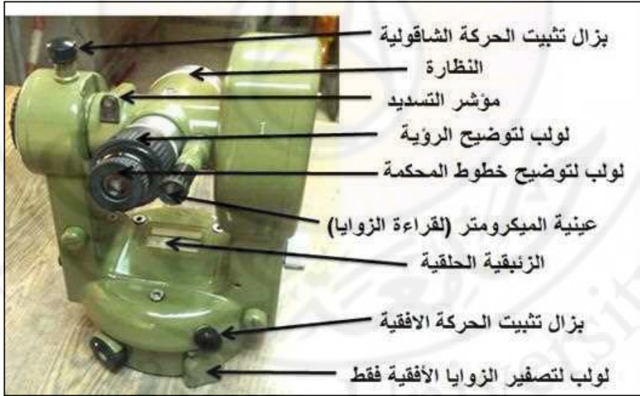
الشكل 6-9 بعض أجزاء جهاز الثيودوليت من نوع كيرن (Kern)
