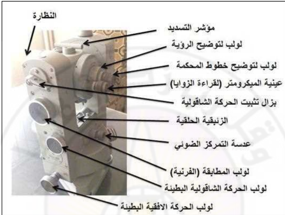
الشكل 6-12 بعض أجزاء جهاز الثيودوليت من نوع زايس من الناحية الأمامية
