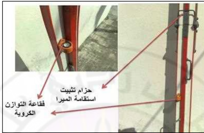
الشكل 4- 20 حزام تثبيت الميرا وفقاعة التوازن
