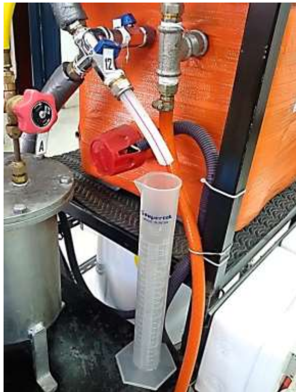
الشكل (d-3-3) أنبوب مدرج لقياس تدفق المضخات
