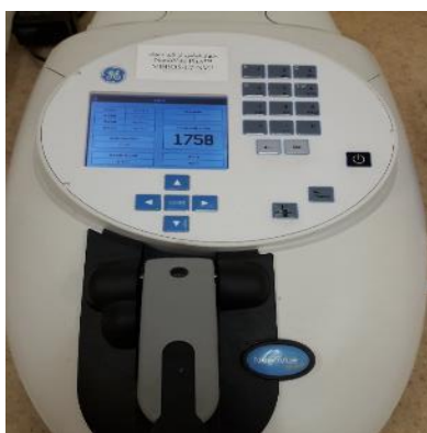
الشكل 8: قياس تركيز عينة الدنا DNA بواسطة جهاز Nanodrop
