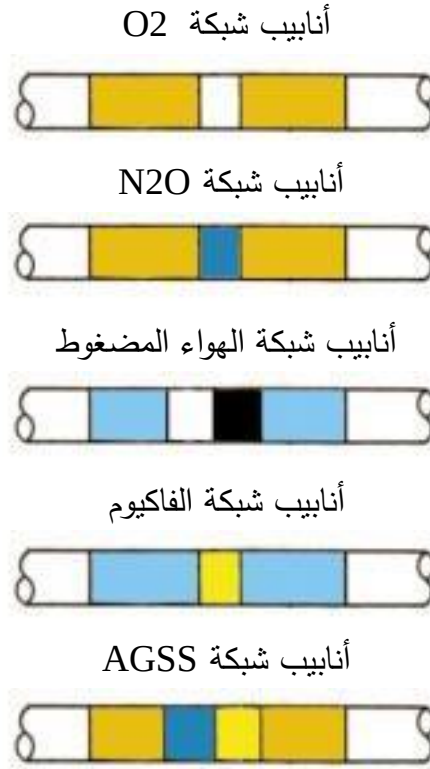
الشكل (6-17) الألوان المستخدمة لتعريف أنابيب شبكات توزيع الغازات [40]
