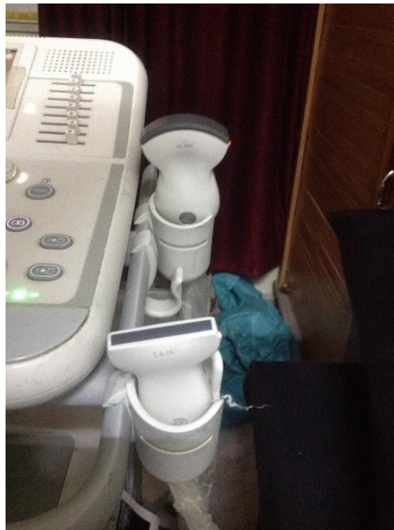
الشكل 52: يظهر في الصورة المسبار الخطي (5-15 MHz) الذي تم استخدامه ضمن الدراسة.
