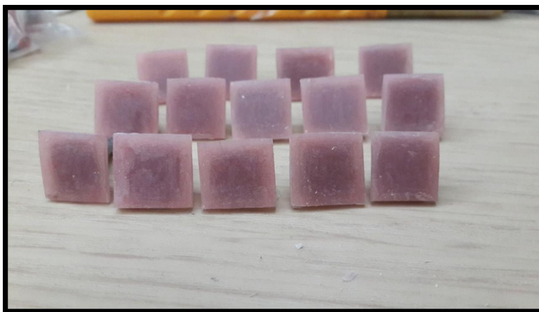
الشكل (2-19) العينات بعد التشذيب والتنعيم
