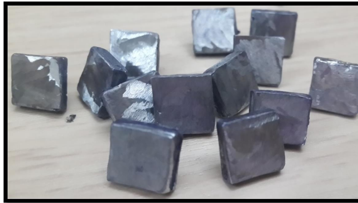
الشكل (2-15) العينات المعدنية بعد تنظيف المسحوق الكاسي
