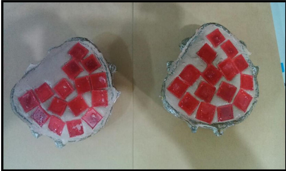
الشكل (2-16) تطبيق الرقاقات الشمعية فوق العينات المعدنية
