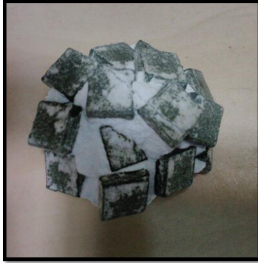
الشكل (2-14) العينات المعدنية بعد الصب
