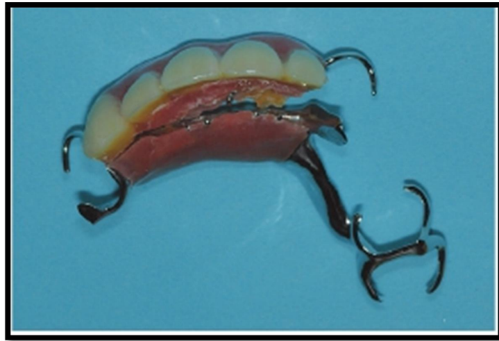
الشكل (2-1) انكسار الراتنج الأكريلي بسبب التسرب المجهري
