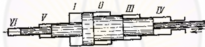
الشكل (10-12) مخطط ضاغط بستة مراحل ويمكابس مختلفة
