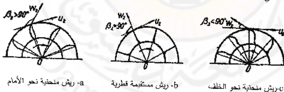
الشكل (4-3) أشكال الريش في الآلات الطاردة تبعاً للزاوية \beta_2
