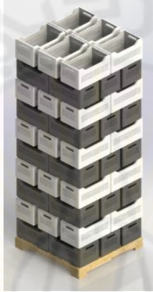
الشكل ٧: طريقة توضع الصناديق على الطبلبات بصورة متصالبة
