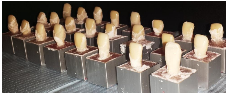
الشكل (29) عينة الأوجه الخزفية بعد تثبيتها على الأسنان الإكريلية
