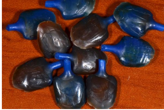
الشكل (24) الأوجه الشمعية بعد تثبيت الأوتاد الشمعية
