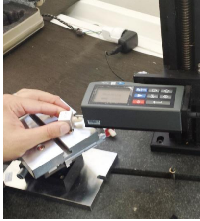
الشكل (30) عينة البحث أثناء اجراء اختبار خشونة السطح
