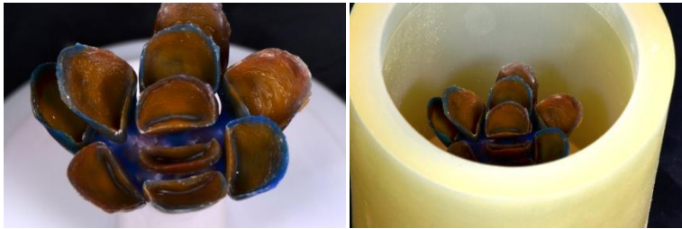
الشكل (25) الأوجه الشمعية بعد تثبيتها داخل البوتقة
