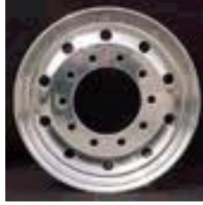
الشكل (1-2) نمط العجلات المصنعة بطريقة الحدادة
