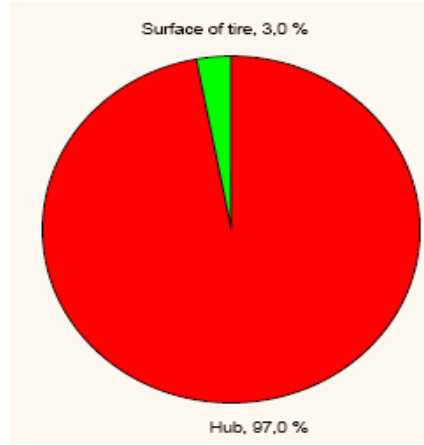
الشكل (6-8) نسب توزع عيوب الانكماش في العجلات المسبوكة
