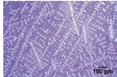
الشكل (4-9) البنية المجهرية لخليطة Al-Si تحوي 12.9% Si مسبوكة بطريقة السباكة التناقلية
