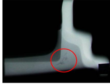
الشكل (7-19) عيب انكماش في عينة مدروسة بواسطة أشعة X في منطقة الاتصال
