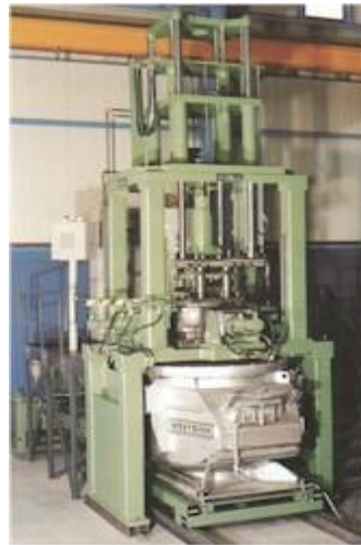
الشكل (4-1) نموذج آلة سباكة بالضغط المنخفض
