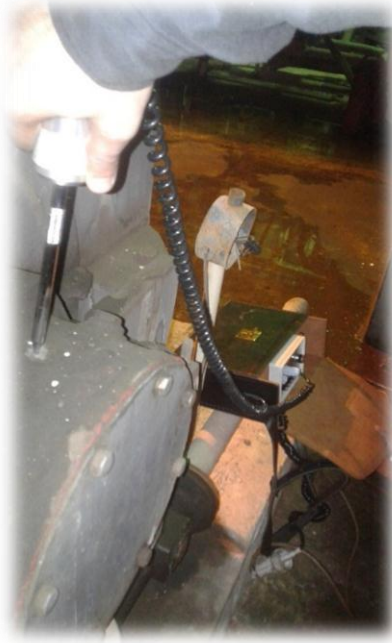
الشكل (75.4) قياس سرعة الاهتزاز في اتجاه المحاور الثلاث لكرسي المحور الخاص بالمحرك الكهربائي
