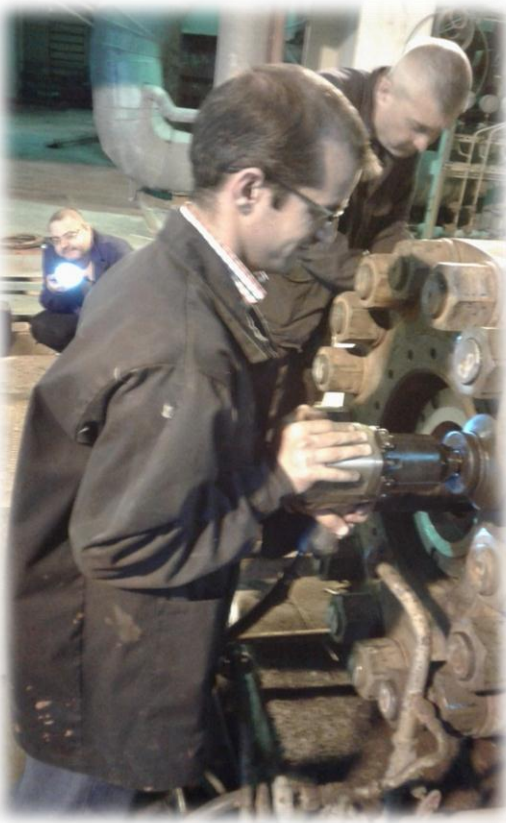
الشكل (43.4) إتمام عملية شد الصواميل باستخدام جهاز شد الصواميل الذي يعمل بالهواء المضغوط
