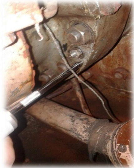
الشكل (72.4) قياس سرعة الاهتزاز في الاتجاه المحوري للترس الامامي والخلفي للمضخة
