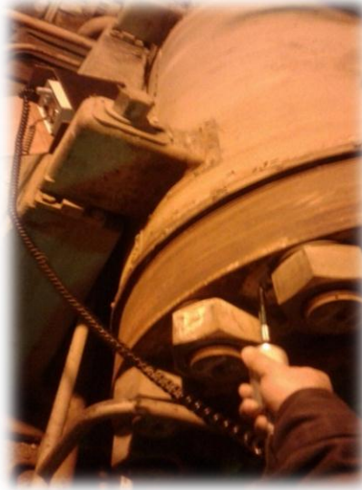
الشكل (72.4) قياس سرعة الاهتزاز في الاتجاه المحوري للترس الامامي والخلفي للمضخة
