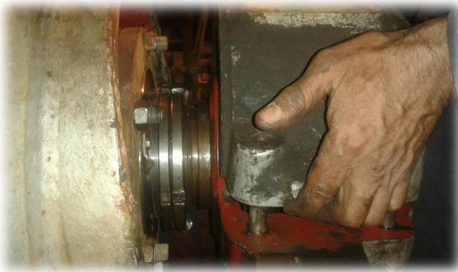
الشكل (63.4) تركيب الجزء العلوي الخارجي لكرسي المحور الانزلاقي وتنصيبه
