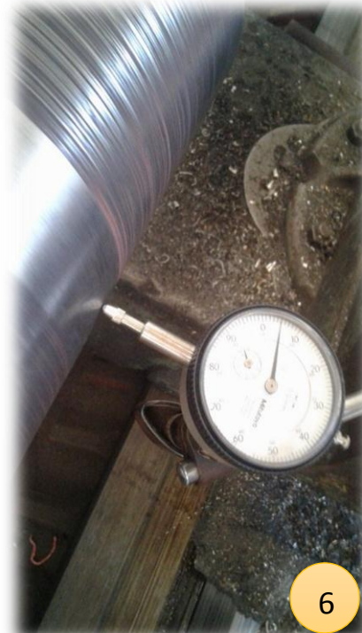
الشكل (14.4) فحص استقامة العمود الرئيسي باستخدام ساعة قياس (دقة قياسها 0.01 mm)
