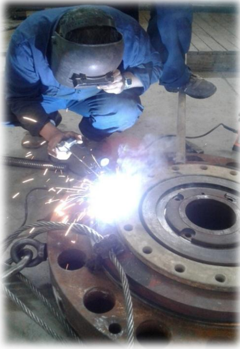
الشكل (25.4) توضيح لطريقة لحام تلقيط لقرص حديد على الوجه العلوي للترس لإنجاز عملية التنقيب
