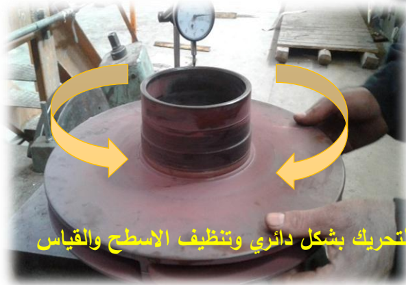
الشكل (16.4) فحص وقياس القرص الدوار لكل مرحلة ضخ بمساعدة ساعة قياس
