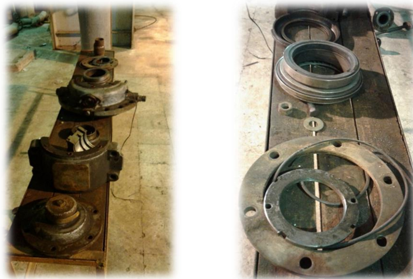
الشكل (55.4) فحص العناصر الميكانيكية المتممة وتحضيرها للتركيب والتجميع النهائي
