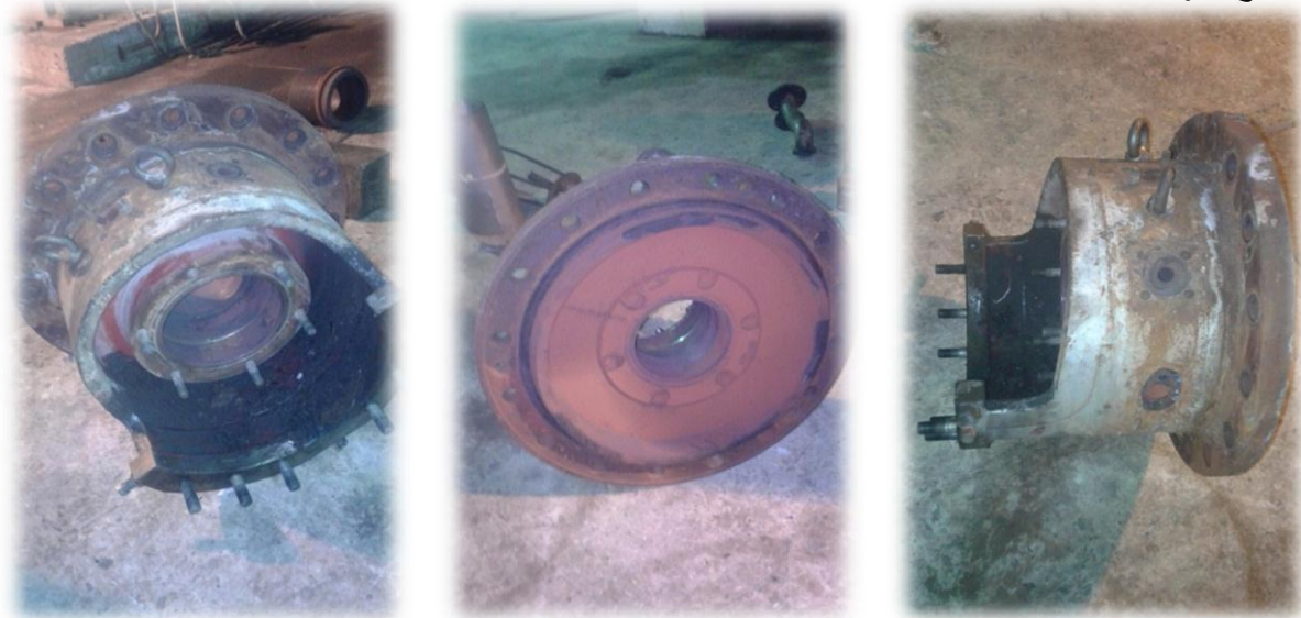
الشكل (36.4) عملية فحص قاعدة تثبيت المحمل الأمامية لمضخة تغذية المرجل قبل التجميع
