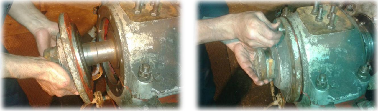
الشكل (64.4) تركيب وتثبيت غطاء كرسي المحور الانزلاقي وبداخله رولمان دحرجي
