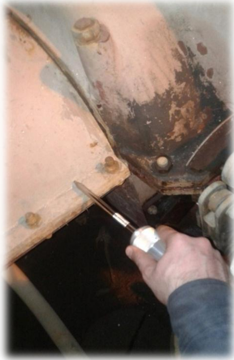
الشكل (74.4) قياس سرعة الاهتزاز في الاتجاه القطري لغطاء المضخة من جهة القارنة
