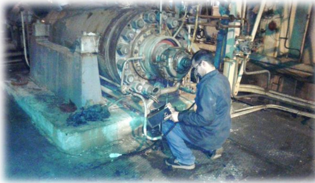
الشكل (69.4) قياس سرعة الاهتزاز في الاتجاه المحوري للمحمل الرأسي (في مقدمة المضخة)
