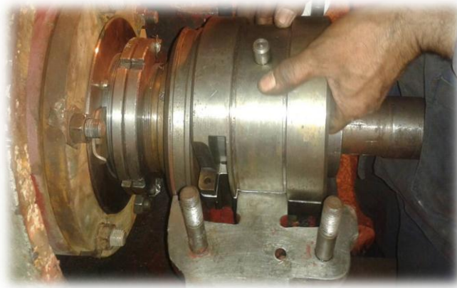
الشكل (62.4) تركيب الجزء العلوي الداخلي لكرسي المحور الانزلاقي وتنصيبه في مكانه
