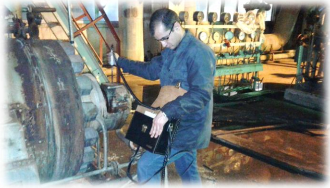
الشكل (70.4) قياس سرعة الاهتزاز في الاتجاه القطري للمحمل بين المضخة والقارئة الهيدروليكية
