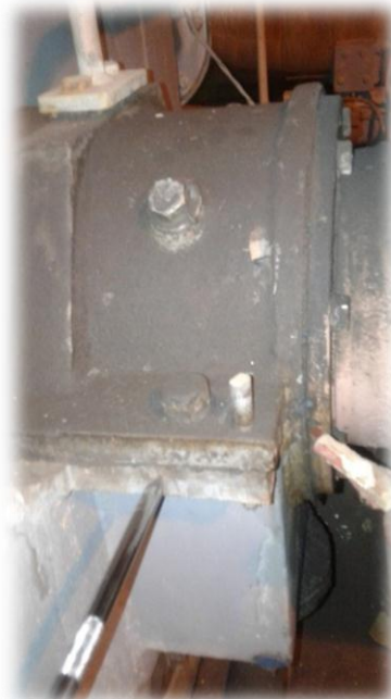
الشكل (75.4) قياس سرعة الاهتزاز في اتجاه المحاور الثلاث لكرسي المحور الخاص بالمحرك الكهربائي
