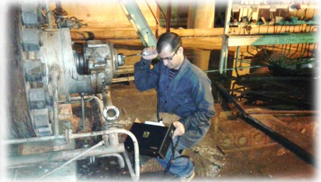
الشكل (69.4) قياس سرعة الاهتزاز في الاتجاه المحوري للمحمل الرأسي (في مقدمة المضخة)
