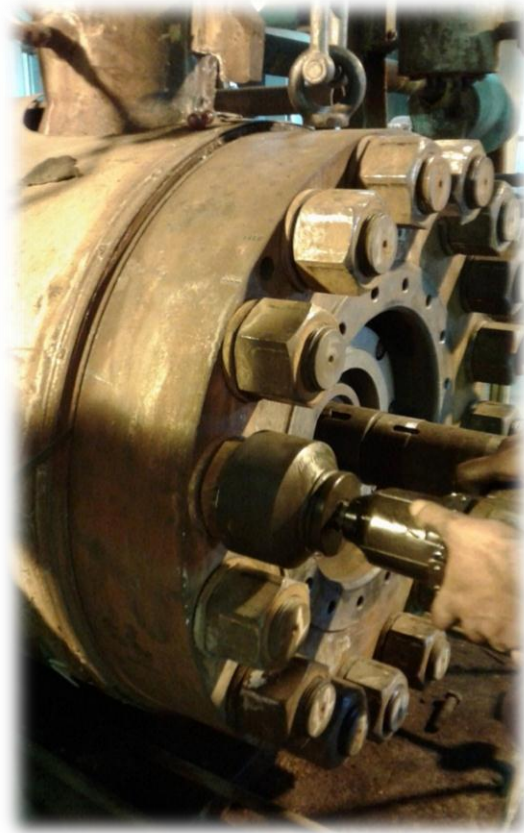
الشكل (43.4) إتمام عملية شد الصواميل باستخدام جهاز شد الصواميل الذي يعمل بالهواء المضغوط
