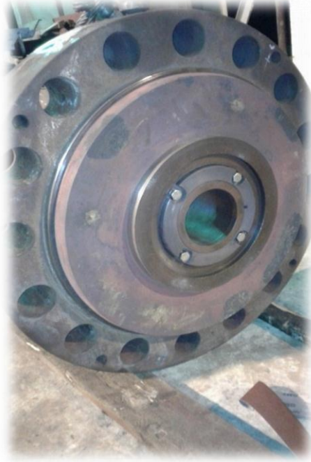
الشكل (28.4) تثبيت سوار الجلبة الأمامي وشد لوالب التثبيت بعد الانتهاء من فتح السن
