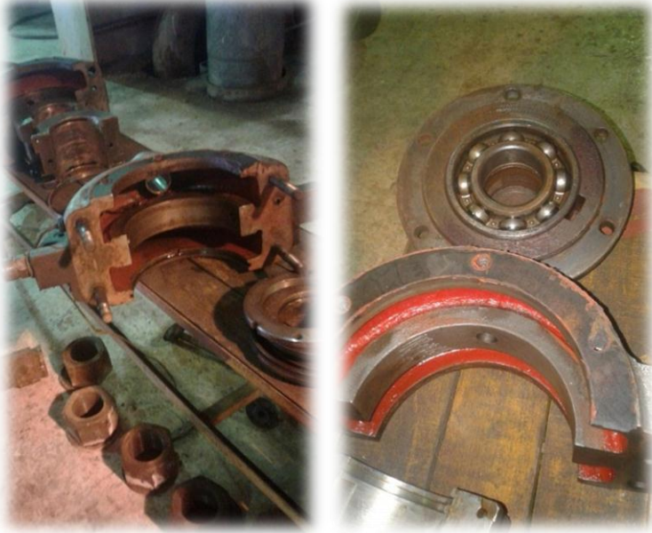
الشكل (35.4) القطع الملحقة لتجميع الجزء الدوار: المحمل ولوالب التثبيت والموانع والأغطية المرفقة.
