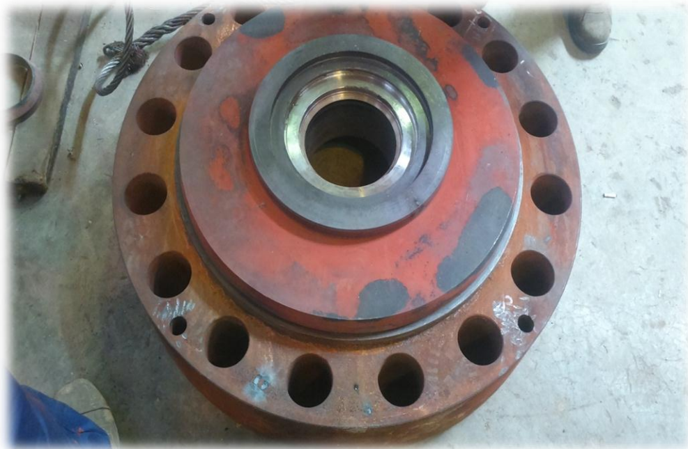
الشكل (22.4) إنجاز الخراطة وتسوية السطح اللازم بعد الانتهاء من عملية اللحام
