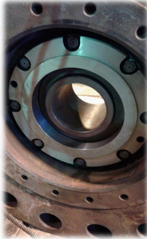
الشكل (29.4) تثبيت سوار الجلبة الخلفي وشد لوالب التثبيت انتهاء مرحلة صيانة الترس الأمامي للمضخة وتثبيت أساور تثبيت الجلبة على الوجهين الأمامي والخلفي للترس
