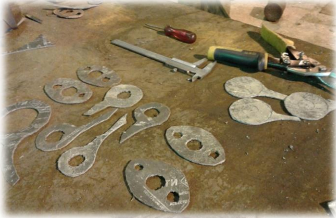
الشكل (53.4) تفصيل مانعات التسرب لوصلات التبريد والتزيت وفق أبعاد مقاطع الوصلات
