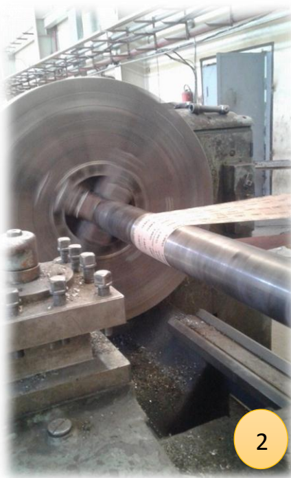
الشكل (13.4) تنظيف العمود الرئيسي من الرواسب والتحضير لفحص استقامته
