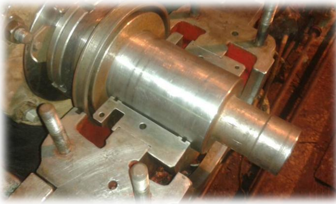
الشكل (61.4) تركيب الجزء الداخلي العلوي والسفلي لكرسي المحور الانزلاقي
