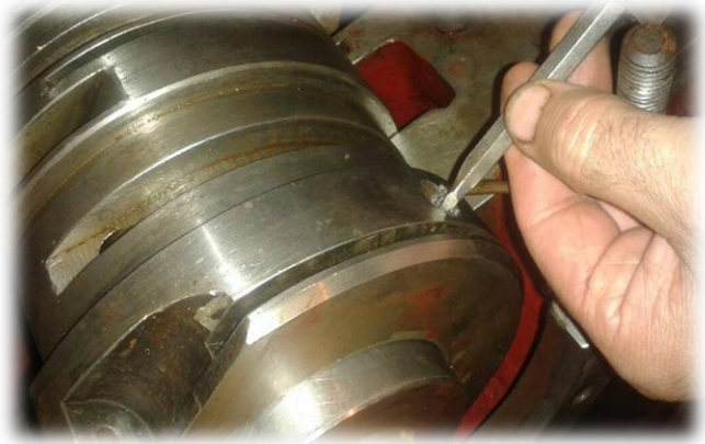
الشكل (62.4) تركيب الجزء العلوي الداخلي لكرسي المحور الانزلاقي وتنصيبه في مكانه
