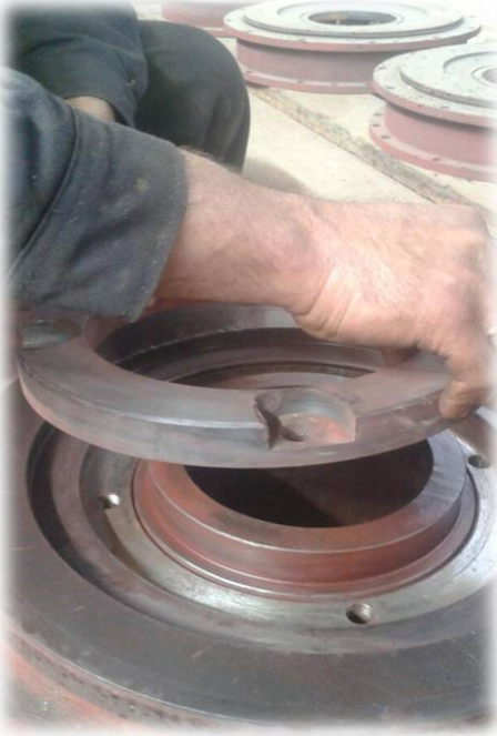
الشكل (28.4) تثبيت سوار الجلبة الأمامي وشد لوالب التثبيت بعد الانتهاء من فتح السن
