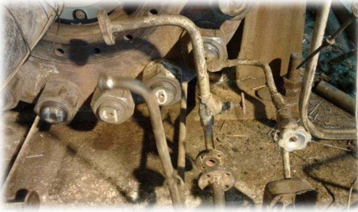
الشكل (53.4) تفصيل مانعات التسرب لوصلات التبريد والتزيت وفق أبعاد مقاطع الوصلات
