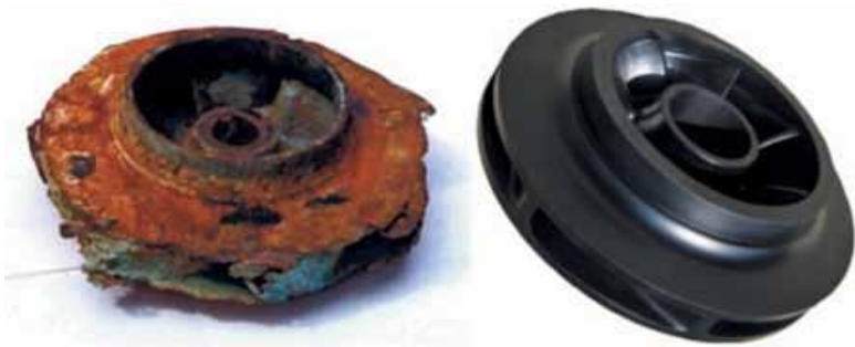
الشكل (7.2) تآكل واهتراء في المروحة نتيجة التكيف، [12]
