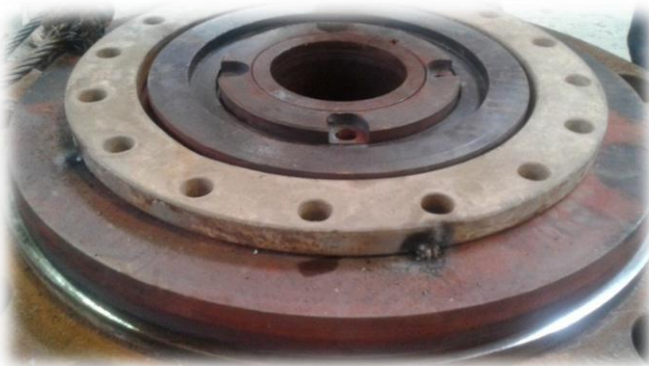
الشكل (26.4) القرص الحديدي بعد تلقيطه باللحام
