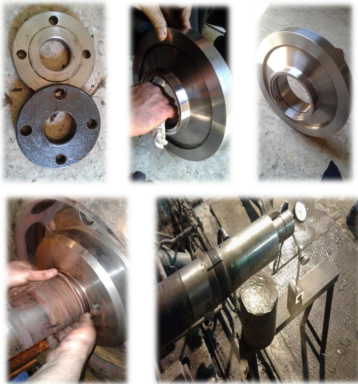
الشكل (49.4) تركيب قرص التوازن وصامولته وقياس مقدار الازاحة
