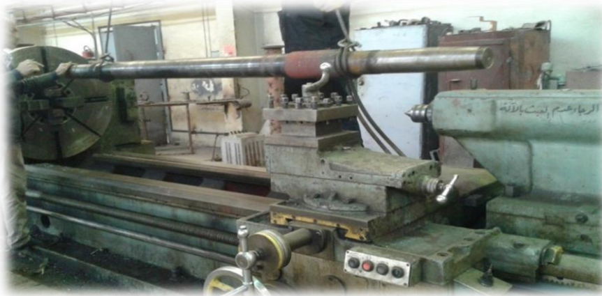
الشكل (12.4) تثبيت المحور الدوار الرئيسي على المخرطة والتحضير لفحصه
