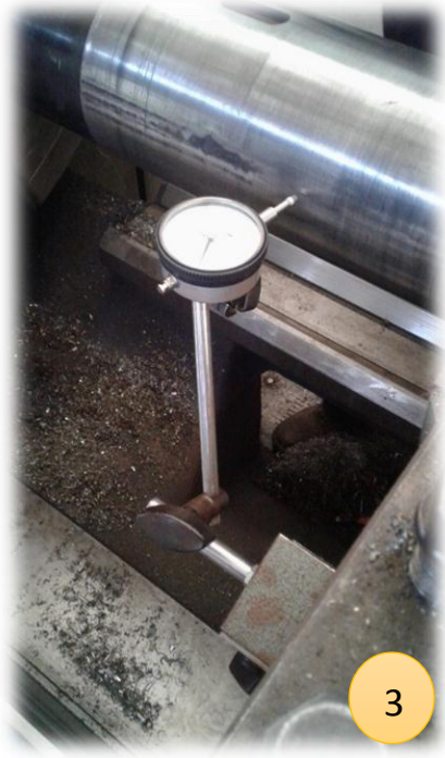
الشكل (13.4) تنظيف العمود الرئيسي من الرواسب والتحضير لفحص استقامته
