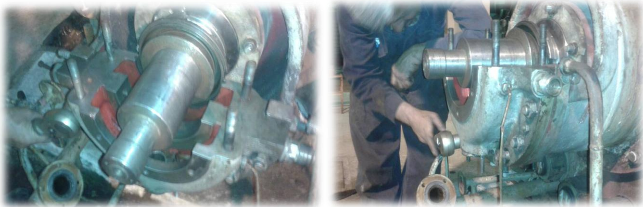
الشكل (60.4) تركيب الجزء السفلي لكرسي المحمل الانزلاقي وتثبيته على قاعدته
