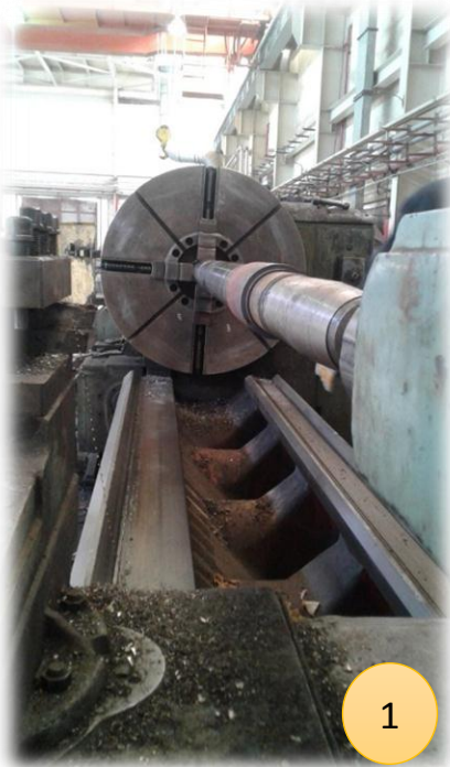
الشكل (13.4) تنظيف العمود الرئيسي من الرواسب والتحضير لفحص استقامته
