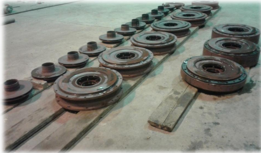
الشكل (11.4) مراحل ضخ مضخة تغذية المرجل بعد فكها عن المحور الدوار الرئيسي
