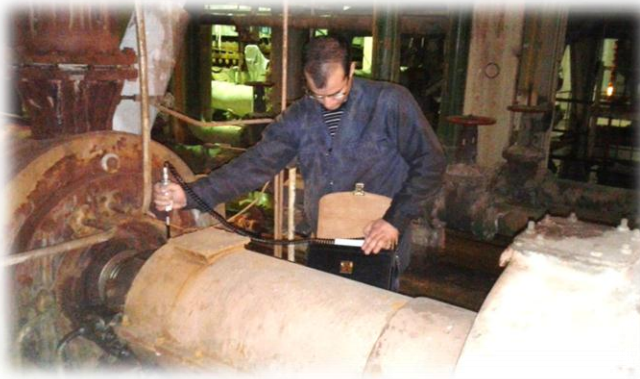
الشكل (71.4) قياس سرعة الاهتزاز في الاتجاه القطري للمحمل الرأسي
