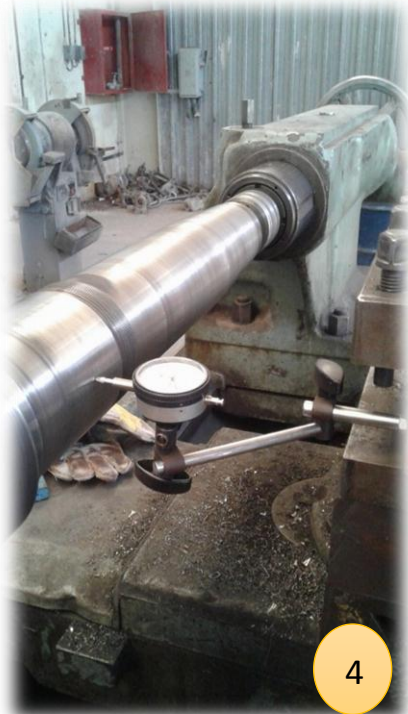
الشكل (14.4) فحص استقامة العمود الرئيسي باستخدام ساعة قياس (دقة قياسها 0.01 mm)
