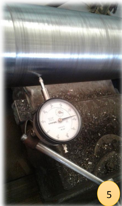
الشكل (14.4) فحص استقامة العمود الرئيسي باستخدام ساعة قياس (دقة قياسها 0.01 mm)
