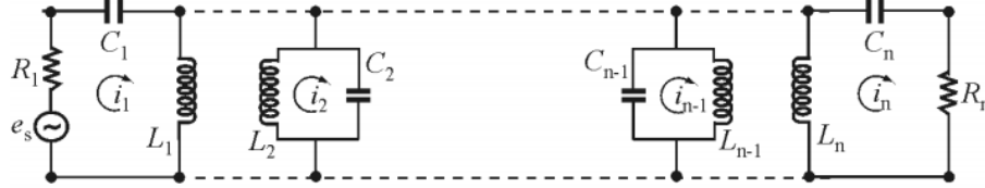
الشكل (12): الدارة المكافئة لـ n رنانة مترابطة [7].
