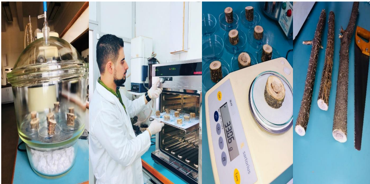
الشكل رقم 32. إخضاع نواتج التقليم لاختبار المحتوى الرطوبة Moisture conten .
