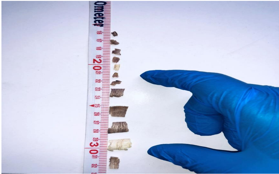
الشكل رقم 8. ابعاد الحبيبات الخشبية المستخدمة في التصنيع.
