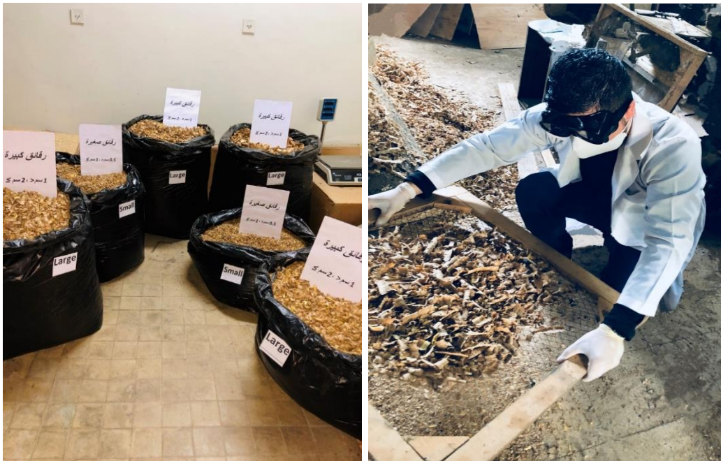
الشكل رقم 35. تنخيل الحبيبات الخشبية وفرزها لحجمين.
