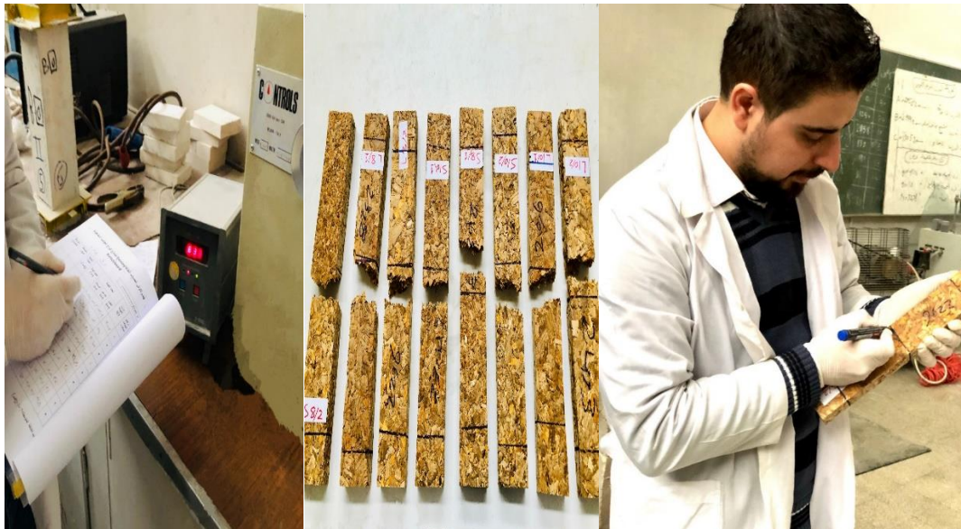
الشكل رقم 39. تحديد البعد بين الركيبتين في اختبار الانحناء الساكن.
