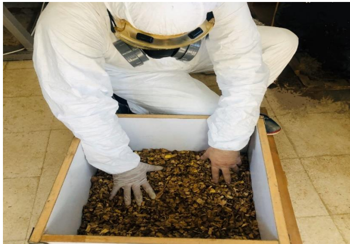
الشكل رقم 37. التوزيع المتجانس للحبيبات الخشبية ضمن القالب الخشبي.
