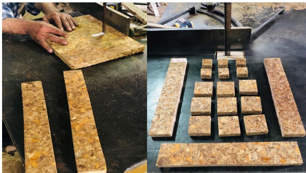
الشكل رقم 36. إعداد العينات الخاصة بالاختبارات الفيزيائية والميكانيكية.
