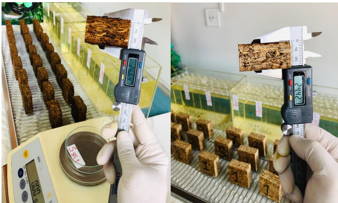
الشكل رقم 29. قياس سماكة عينات اختبار الانتباج قبل عملية النقع وبعدها .
