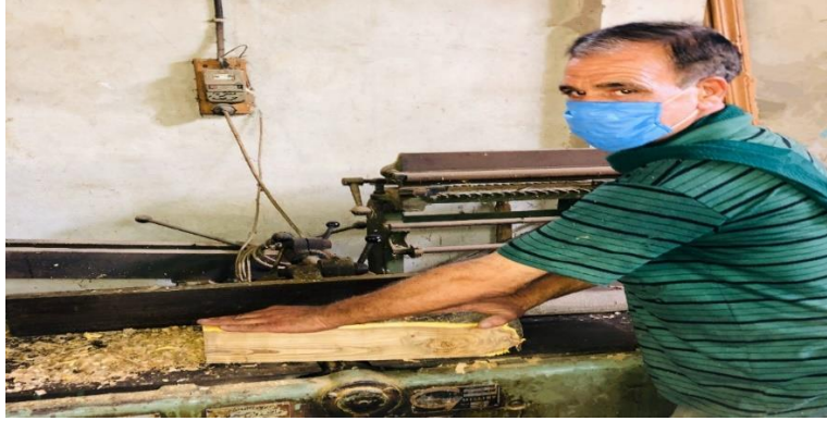
الشكل رقم 4. فرم الكتل الخشبية بوساطة الرابوب.
