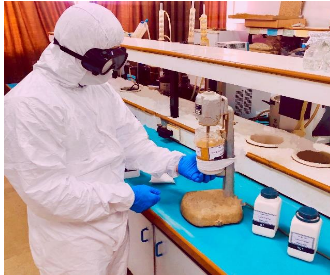
الشكل رقم 12. تحضير اليوريا فورم ألدهيد وسلفات الأمونيوم بواسطة الخلاط الميكانيكي.
