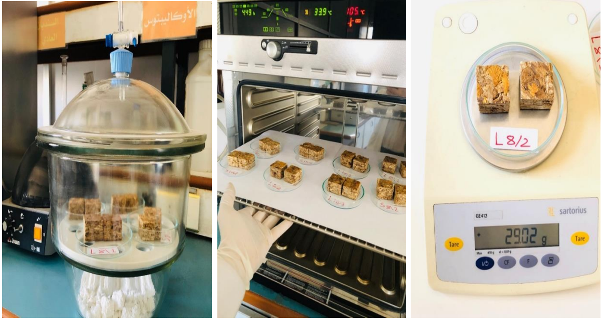
الشكل رقم 25. اخضاع العينات لاختبار المحتوى الرطوبي.
