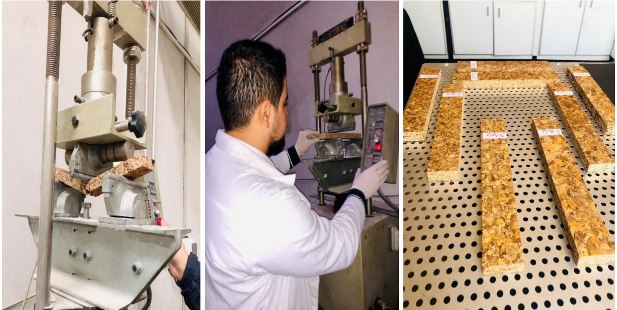
الشكل رقم 31. تطبيق الاختبار بعد تحديد البُعد بين ركيزتي الجهاز.
