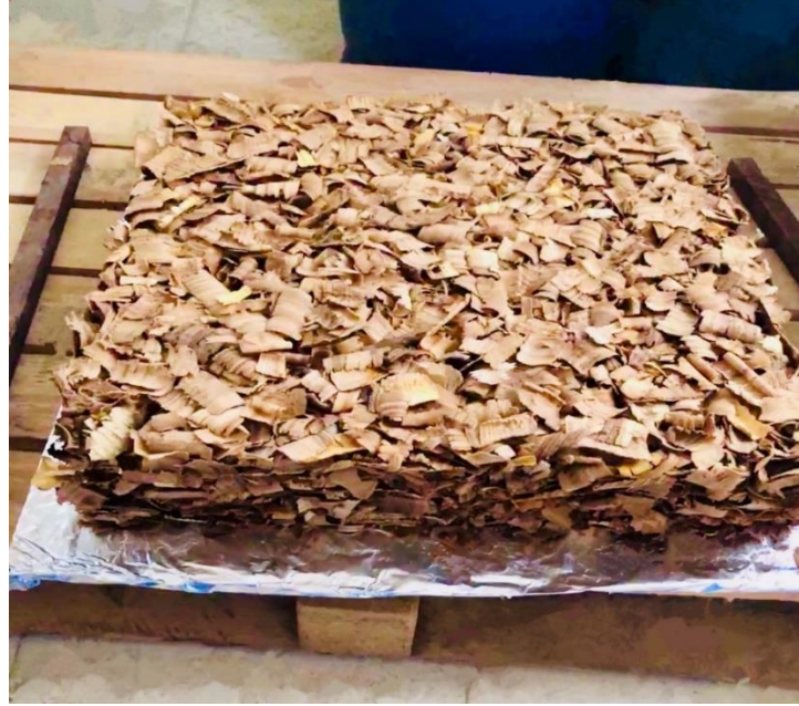
الشكل رقم 18. فرشاة الحبيبات الخشبية الناتجة عن الكبس الأولي.
