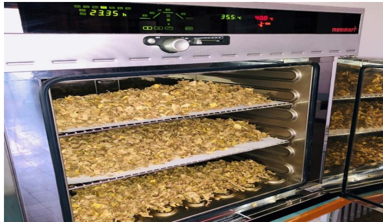
الشكل رقم 9. وضع الحبيبات الخشبية في المجفف الحراري للوصول لرطوبة نحو 5%.
