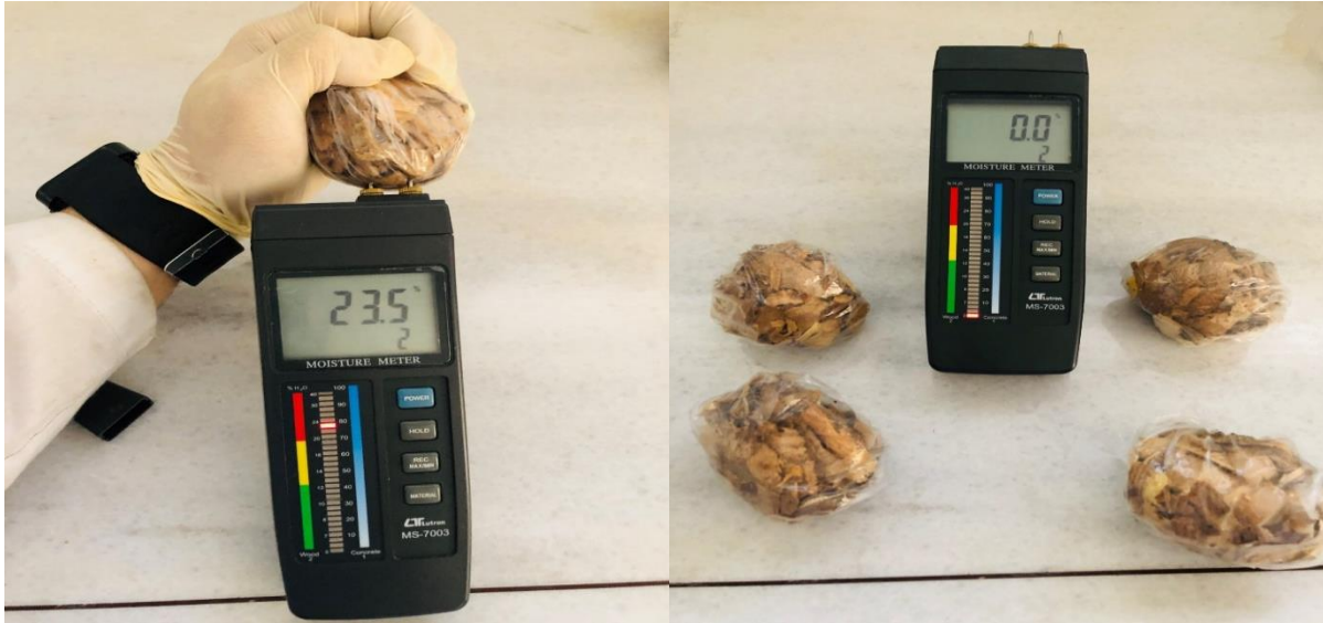
الشكل رقم 14. قياس رطوبة الحبيبات المغراة بأسلوب العينات التجميعية.
