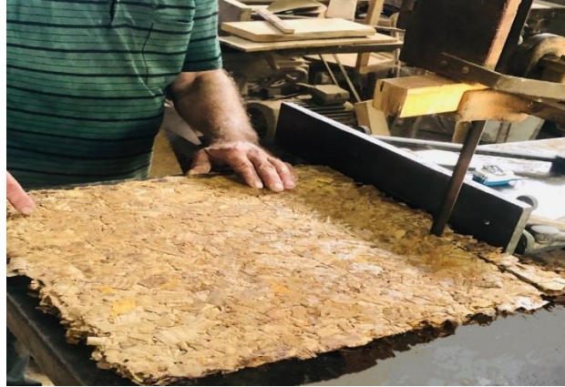
الشكل رقم 22. إزالة 5 سم من حواف اللوح لاستبعاد رداءة التأثير الحافي للكبس.
