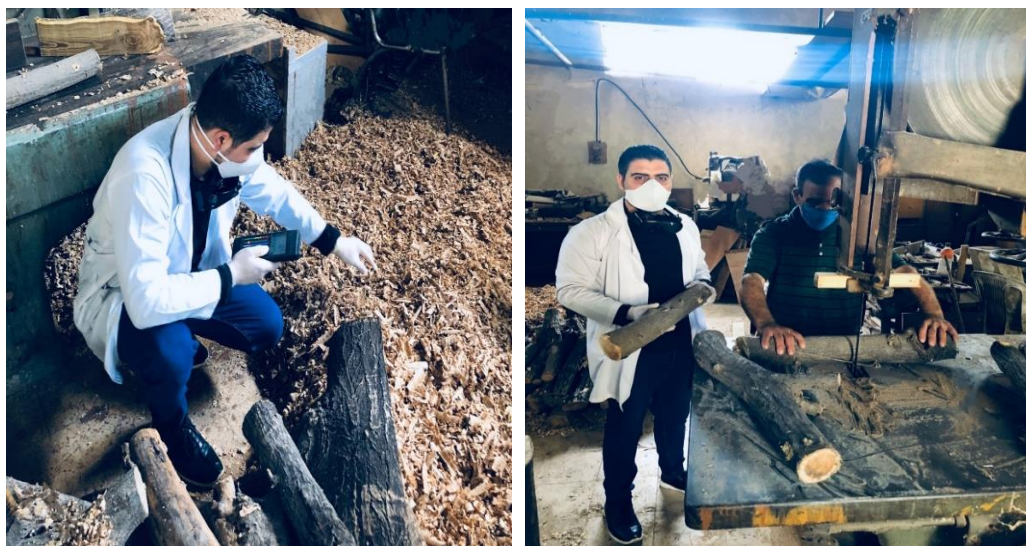
الشكل رقم 34. تحديد أبعاد الأفرع وقياس رطوبة الحبيبات بعد الفرز
