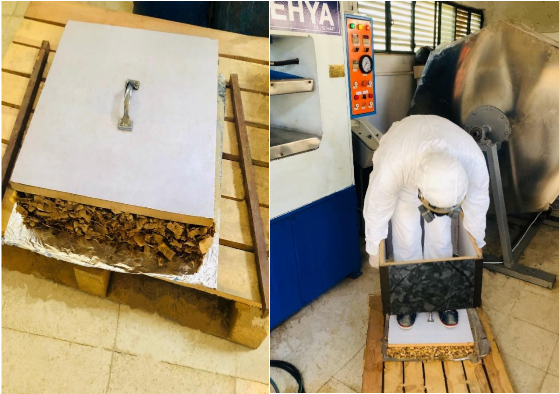
الشكل رقم 17. تشكيل أولي للحبيبات المغرة ورفع إطار التحديد الخشبي.
