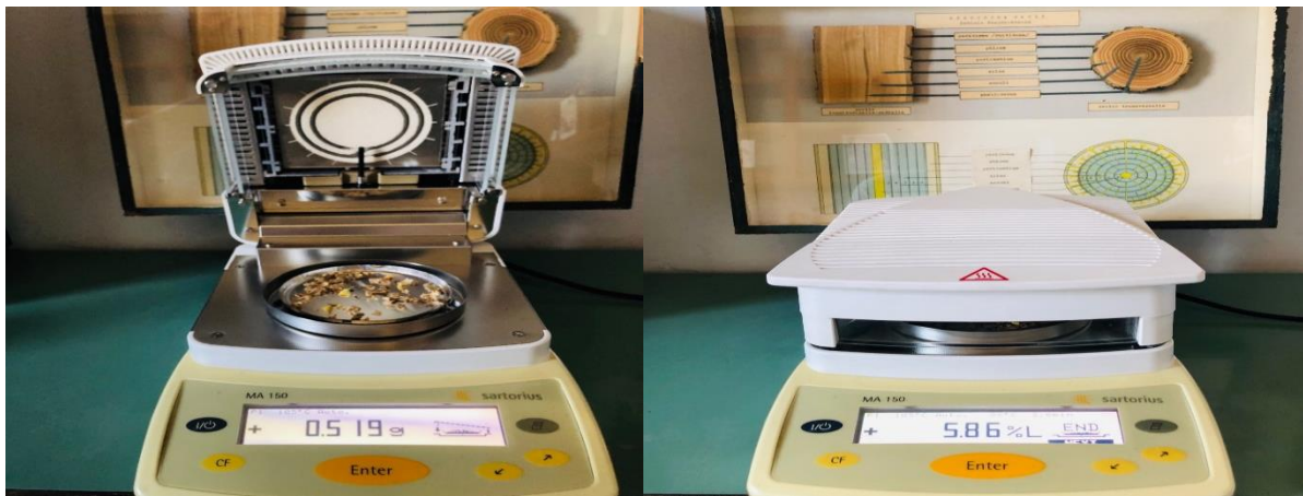
الشكل رقم 10. قياس رطوبة الحبيبات الخشبية بجهاز Sartorius AG بعد التجفيف مباشرة.
