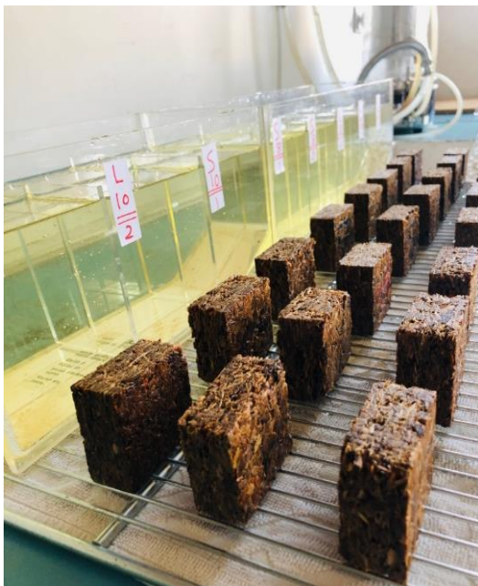
الشكل رقم 38. تجفيف العينات الخشبية بعد المعاملة المائية في الأحواض
