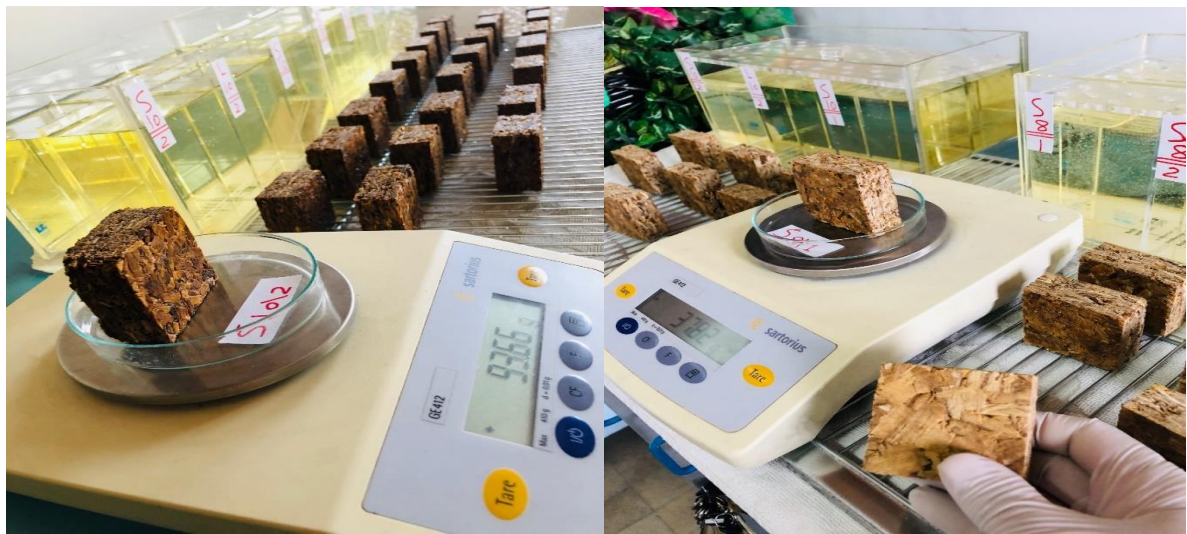
الشكل رقم 28. وزن عينات اختبار الامتصاص قبل عملية النقع وبعدها.
