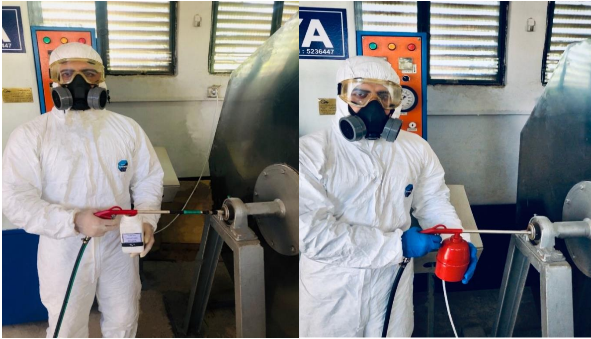
الشكل رقم 13. البخ الرذاذي لسلفات الأمونيوم واليوريا فورم ألدهيد على الحبيبات الخشبية ضمن خلاط العينات.
