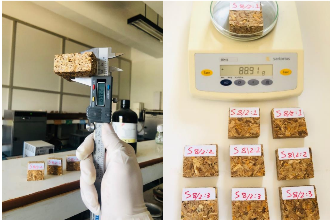
الشكل رقم 26. وزن العينات الخاصة باختبار الكثافة وقياس أبعادها.
