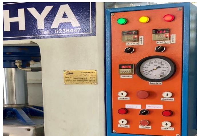
الشكل رقم 19. معايرة الحرارة والضغط والمؤقت الزمني في المكبس الهيدروليكي الحراري.
