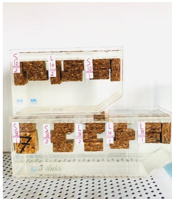
الشكل رقم 38. تجفيف العينات الخشبية بعد المعاملة المائية في الأحواض
