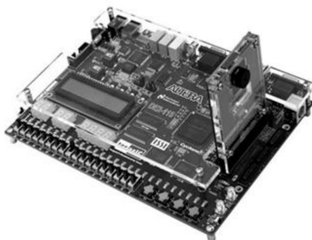
الشكل (9.5): ربط الكاميرا TRDB_D5M بالبطاقة DE2_115 [49]
