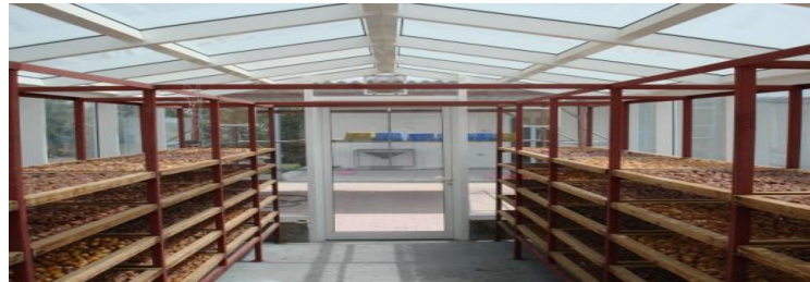
الشكل (2) التجفيف الشمسي الصناعي
