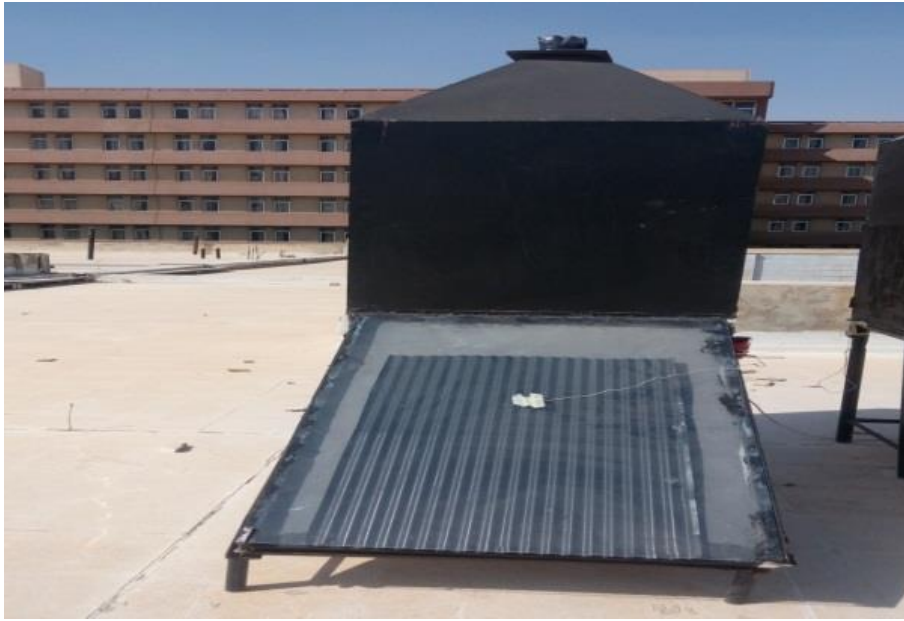
الشكل (7) صورة فوتوغرافية للمجفف الشمسي غير المباشر
