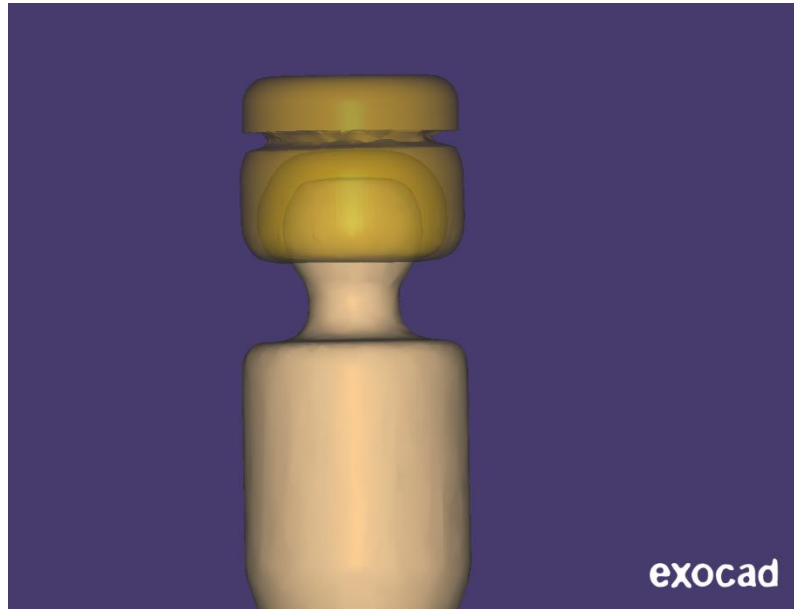
الشّكل رقم (23): الشّكل النّهائيّ لتصميم الوصلة الكرويّة والغطاء المُثَبَّت.
