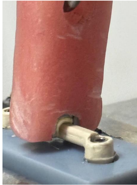
الشكل (2-37) انطباق مشبك PEEK على العارضة PEEK لبدء اختبار الشد على المجموعة 1 من مشابك PEEK.
