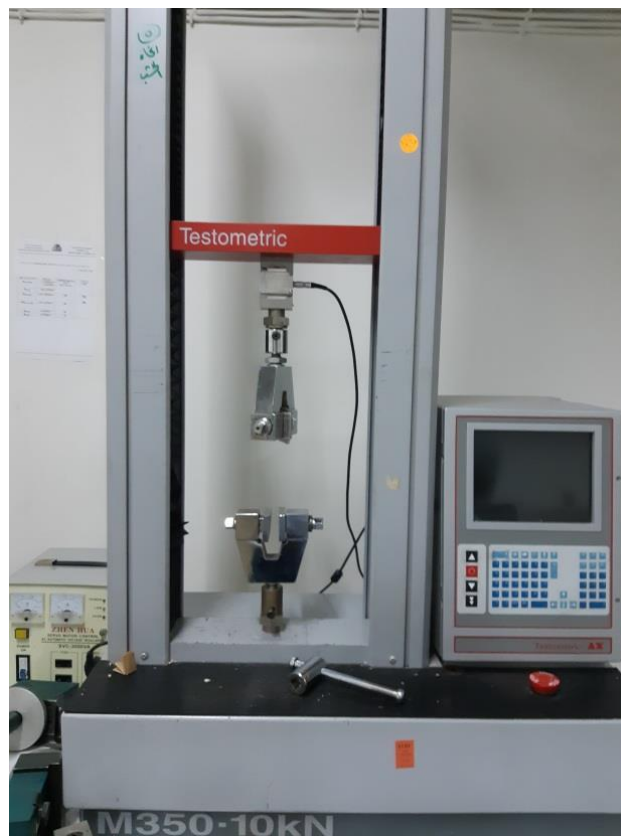
الشكل (2-7): جهاز الاختبارات الميكانيكية المستخدم لقياس قوة الشد.
