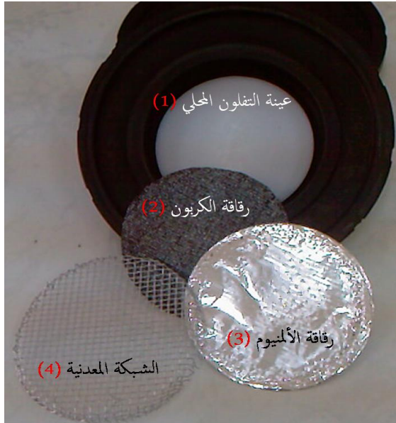
الشكل (34-3) تثبيت التفلون المحلي ورقاقة الكربون على الحامل البلاستيكي مع وجود باقي المكونات
