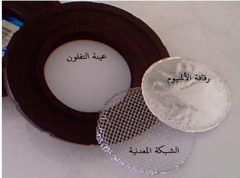
الشكل (31-3) تثبيت عينة التفلون المحلي على الحامل مع الحفاظ على باقي المكونات
