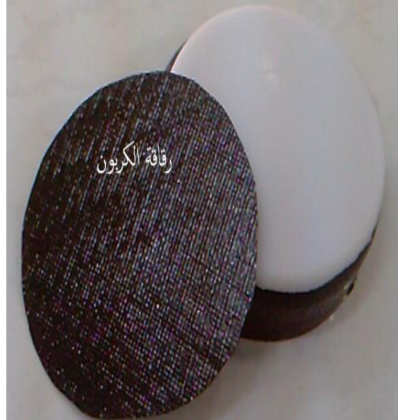
الشكل (34-3) تثبيت التفلون المحلي ورقاقة الكربون على الحامل البلاستيكي مع وجود باقي المكونات
