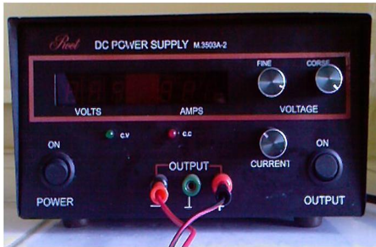
الشكل (1-3) مولد الجهد المنخفض
