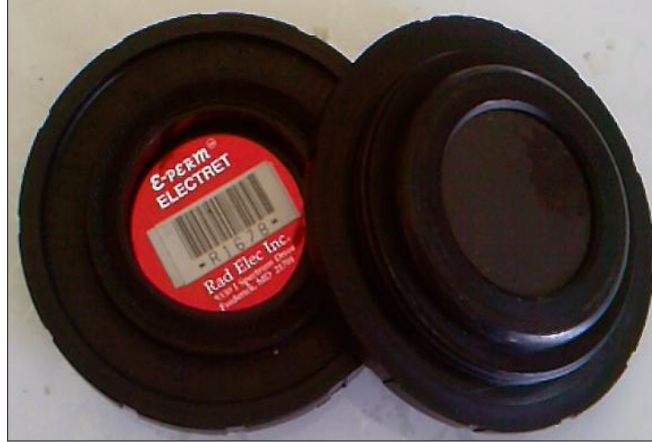
الشكل (10-2) كاشف الإلكتريت ذو اللصاقة الحمراء
