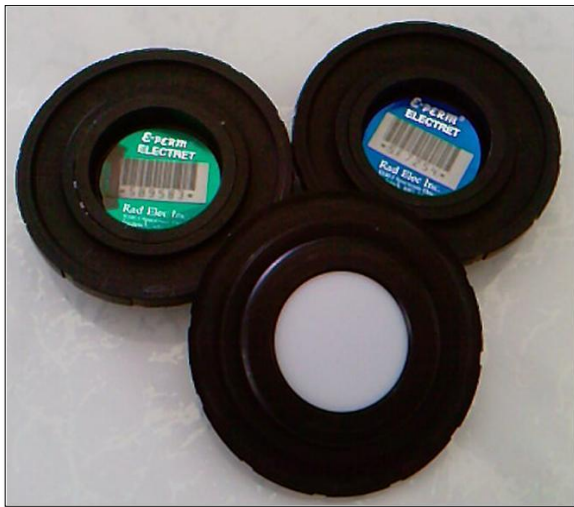
الشكل (9-2) كاشف الإلكتريت ذو اللصاقة الزرقاء والخضراء
