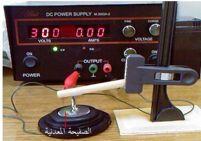
الشكل (5-3) وصل الصفيحة المعدنية إلى القطب السالب لمولد الجهد
