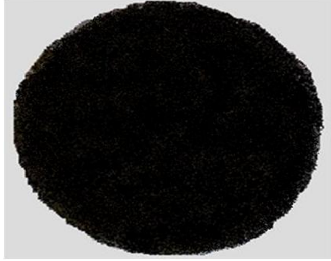
الشكل (35-3) الوجه الخلفي لعينة التفلون المحلي التي تم طليها بالكربون
