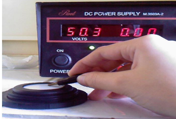
الشكل (3-6) حك سطح الإلكتريت باستخدام الكترود موصول إلى القطب الموجب لمولد الجهد
