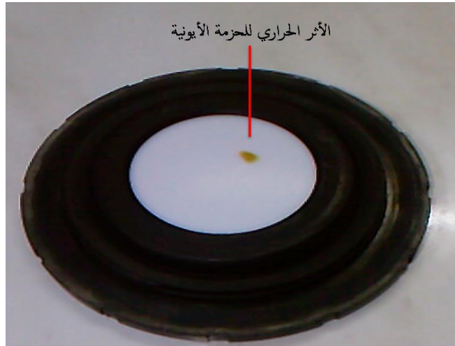
الشكل (9-3) الأثر الحراري لحزمة الجسيمات الأيونية
