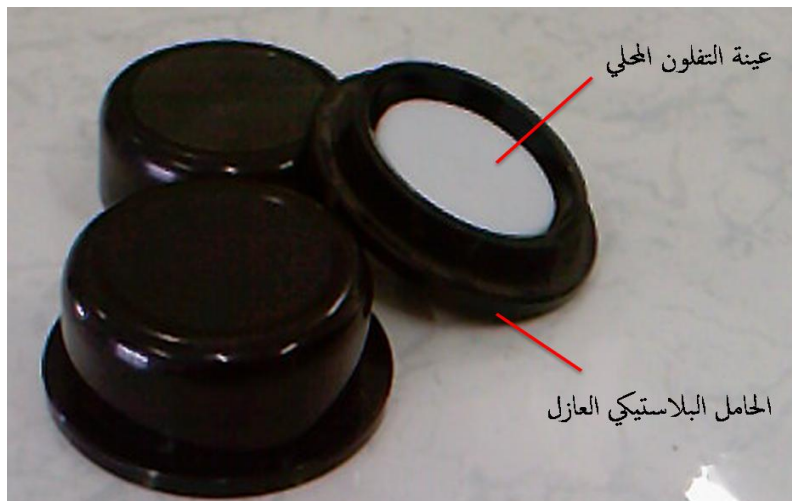
الشكل (32-3) تثبيت عينات التفلون على الحوامل البلاستيكية الجديدة
