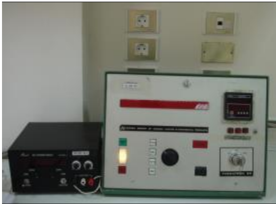
الشكل (12): الجهاز المرفق مع جهاز المعالجة الشعاعية الكوبالت- 60 لتحديد معدل الجرعة و الزمن .
