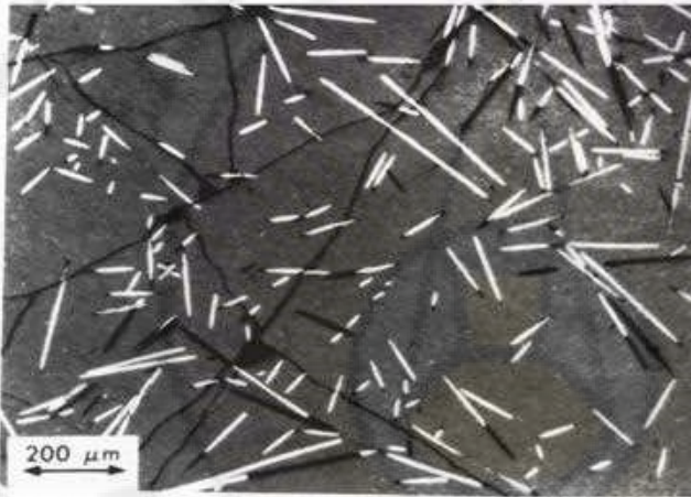
الشكل (34-11) صورة مجهرية للمادة المركبة المصنعة من ألياف الكربون القصيرة ضمن مادة حاضنة من المقنزيا. حدث تشقق المادة الحاضنة كنتيجة لاختلافات التقلص الحراري خلال التبريد بعد التصنيع.
