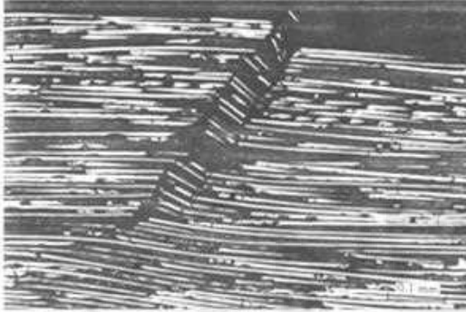
الشكل (19-8): صورة مجهرية لمقطع مصقول من عينة ألياف كربونية / راتنج إيبوكسي، تظهر العقد الالتوائية المتشكلة في منطقة الضغط لعينة اختبرت عند أربع نقاط التواء .
