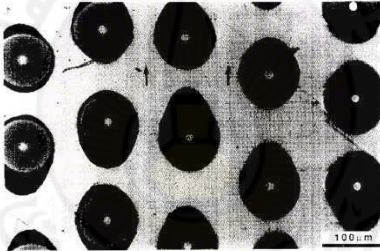
الشكل (10-16) صورة بمجهر المسح الإلكتروني (SEM) لمقطع مصقول قرب سطح التحطم للمادة المركبة Ti-6 Al-4V/30%SiC تحت تأثير تحميل عرضي عند إجهاد 25MPa و بدورة حرارية بين 400\text{--}700\text{ }^{\circ}\text{C} (بمعدل 100\text{ }^{\circ}\text{C} ) بالدقيقة. اتجاه التحميل موضح بالأسهم.
