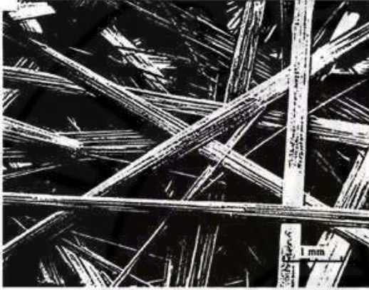
الشكل (8-3) صورة بمجهر المسح الإلكتروني لنسيج متشابك قبل التخلخل بالريزين.
