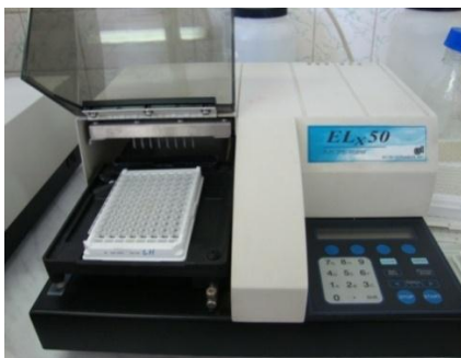
صورة رقم (24) تظهر الجهاز الغاسل washer لـ إليزا من طراز ELX50 Biotek
