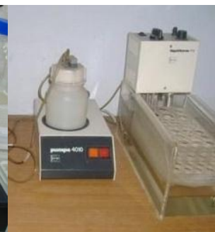
صورة رقم (23) تظهر جهاز الفوتوميتر PHotometer 4010 وهو من إنتاج شركة Med Lab Germany
