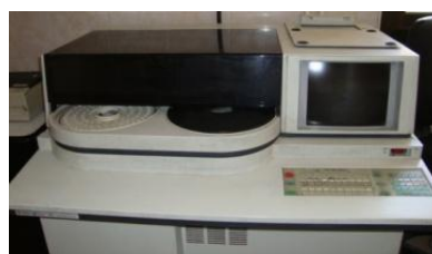
صورة رقم (27) تظهر جهاز الكيمياء الآلي: من إنتاج شركة Roche العالمية Hitachi Automated وهو من طراز Analyzer 704
