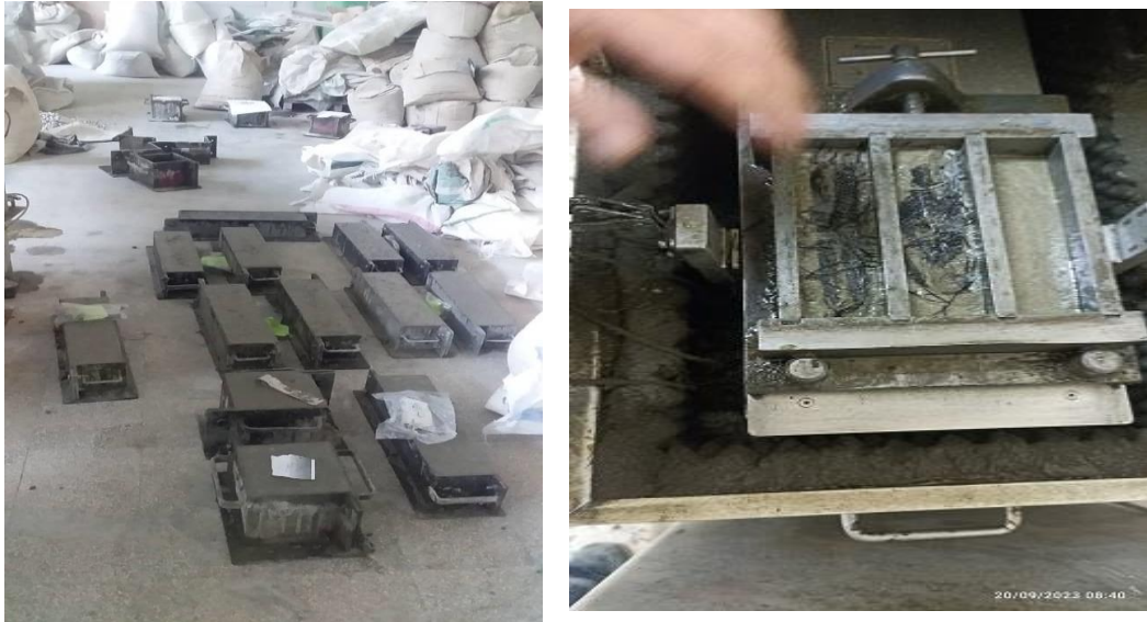
الشكل (3-4) قوالب المونة والخرسانة الاسمنتية
