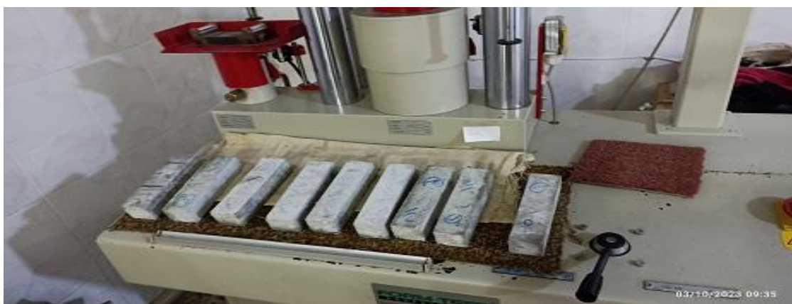
الشكل (12-4) العينات الإسمنتية المدعمة بطبقات النسيج المحسن بالإيبوكسي المقسي كانت نتائج الاختبارات موضحة ضمن الجداول التالية:
