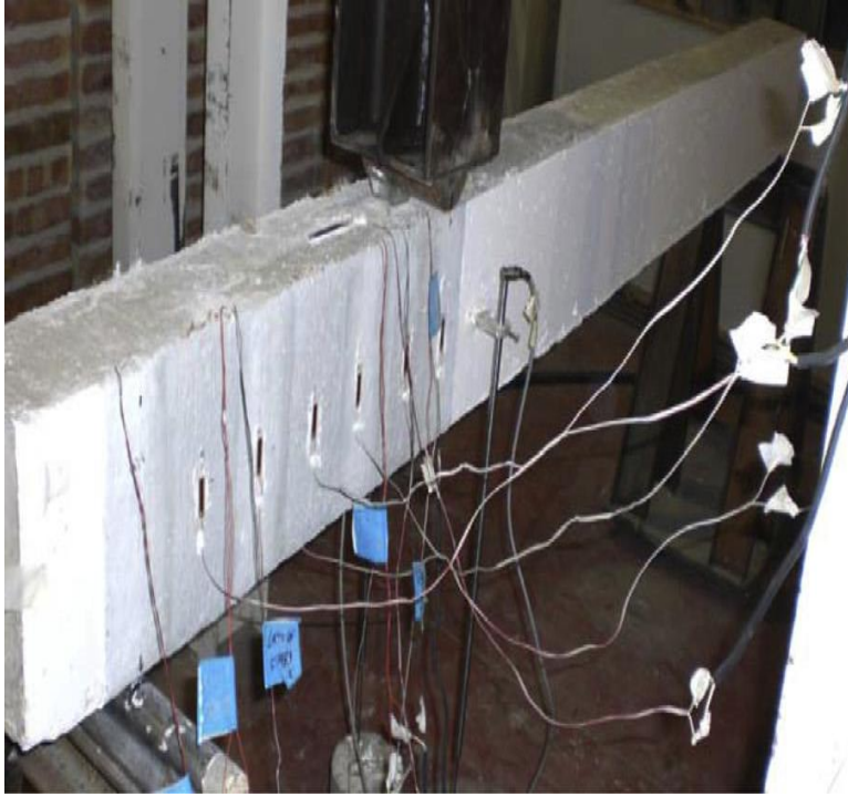
الشكل (7-2) اختبار الاسمنت المقوى بنسيج البولي بروبيلين [12]
