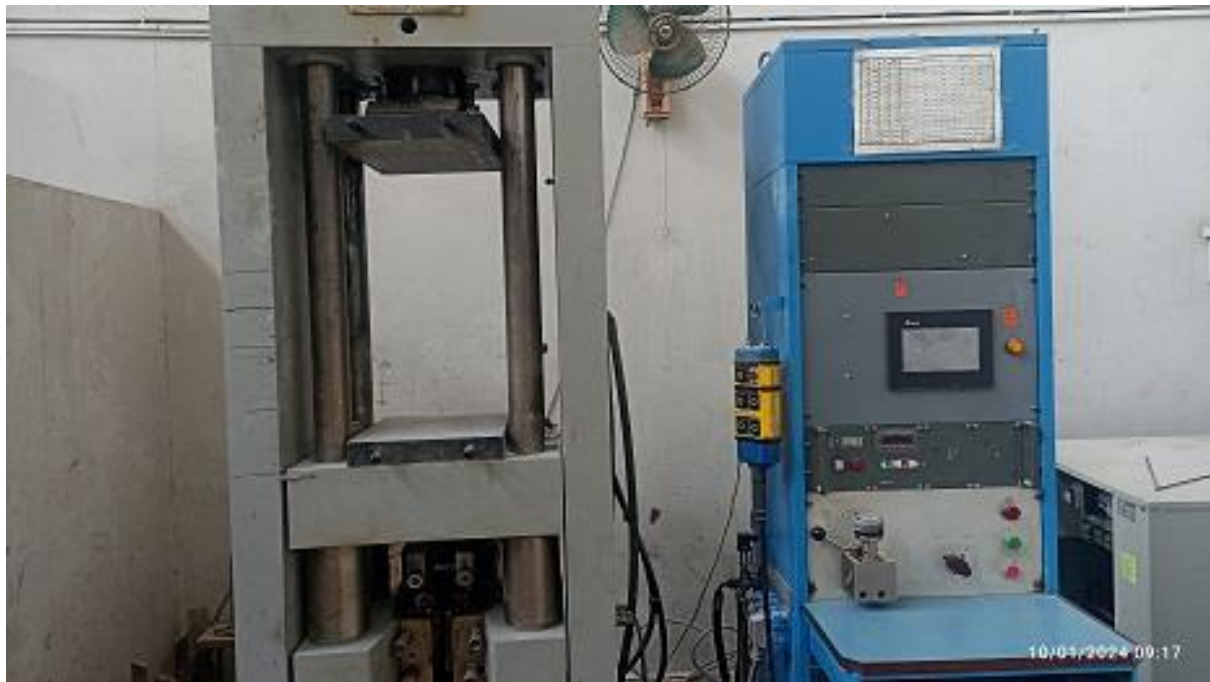
الشكل (4-6) جهاز اختبار الانعطاف للخرسانة
