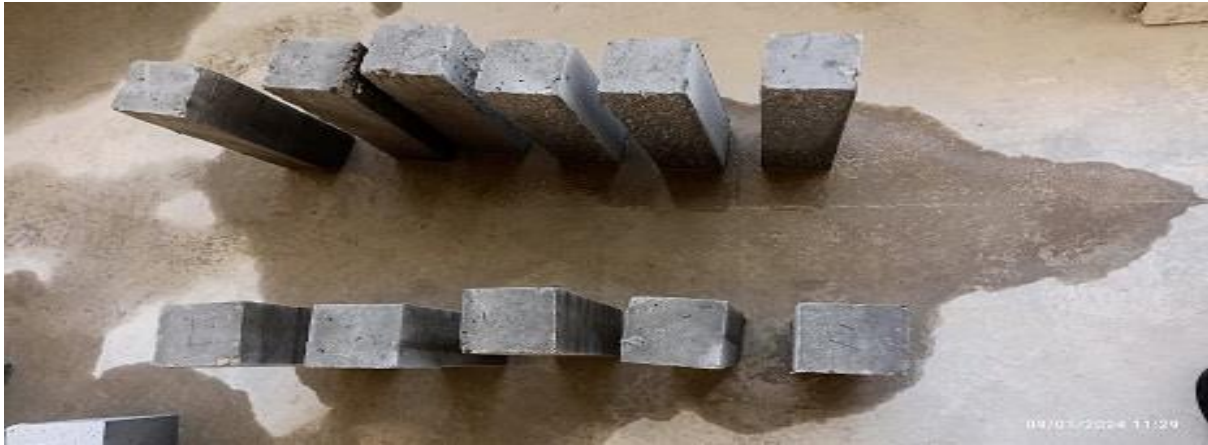
الشكل (4-18) عينات الخرسانة بعد اخراجها من الماء
