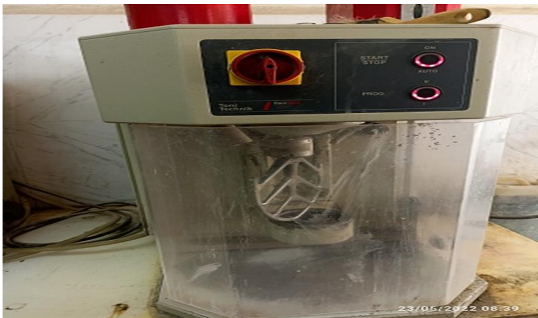
الشكل (4-4) جهاز لخلط مكونات المونة الاسمنتية
