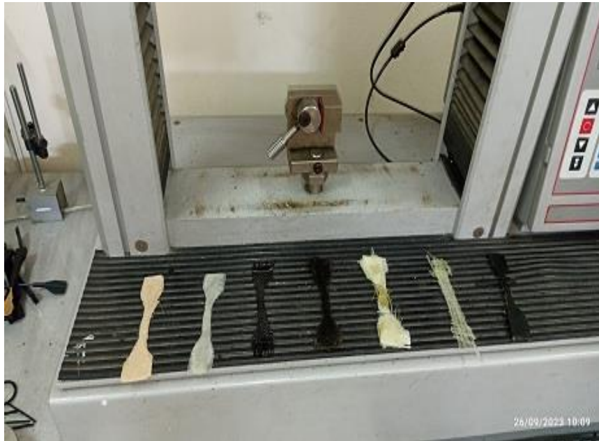
الشكل (4-28) عينات المواد النسيجية المركبة على جهاز اختبار الشد
