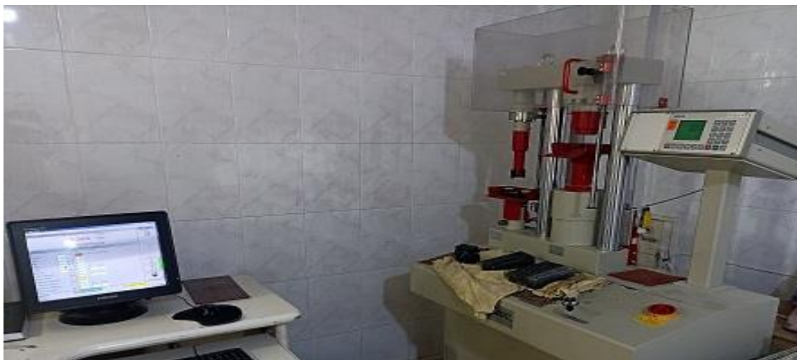
الشكل (2-4) جهاز اختبار الضغط والانعطاف للمونة الاسمنتية
