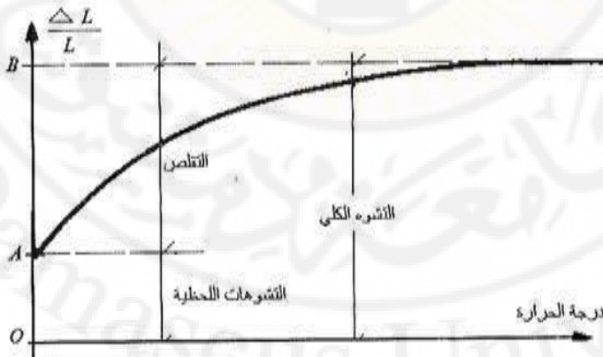
الشكل (3-9) أثر الحرارة على انكماش الخرسانة.
