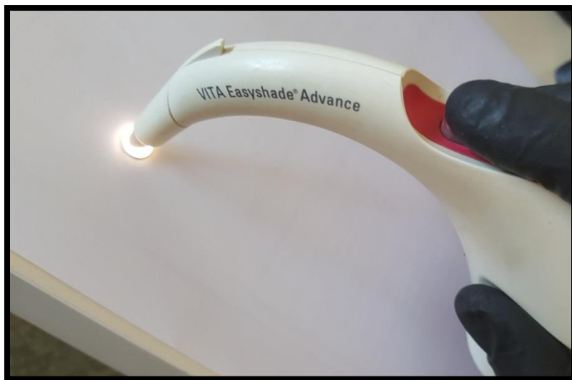
الشكل (38) يبين قياس اللون للعينات وكيفية وضع رأس الجهاز.
